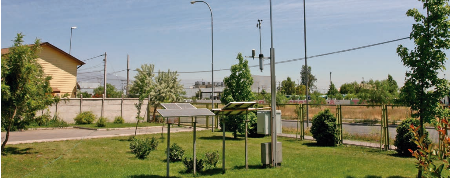
Terminales de Monitoreo de Ruido
