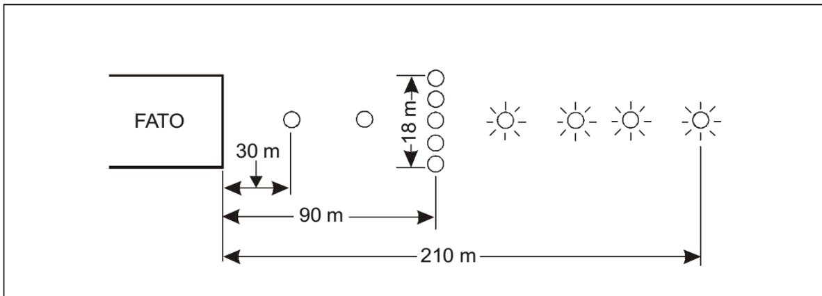
Figura A-5-15. Sistema de luces de aproximación
