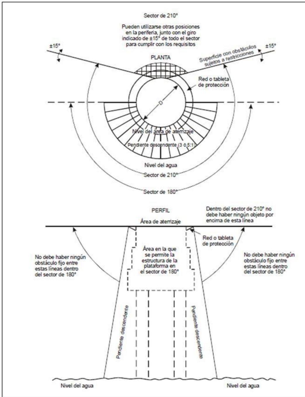
Figura A-4-7. Sector despejado de obstáculos de una heliplatforma
