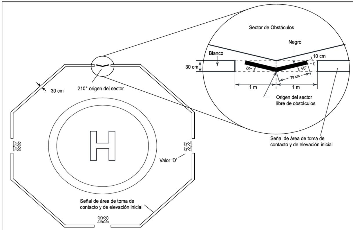
Figura A-5-9. Señal de sector despejado de obstáculos de heliplatforma
