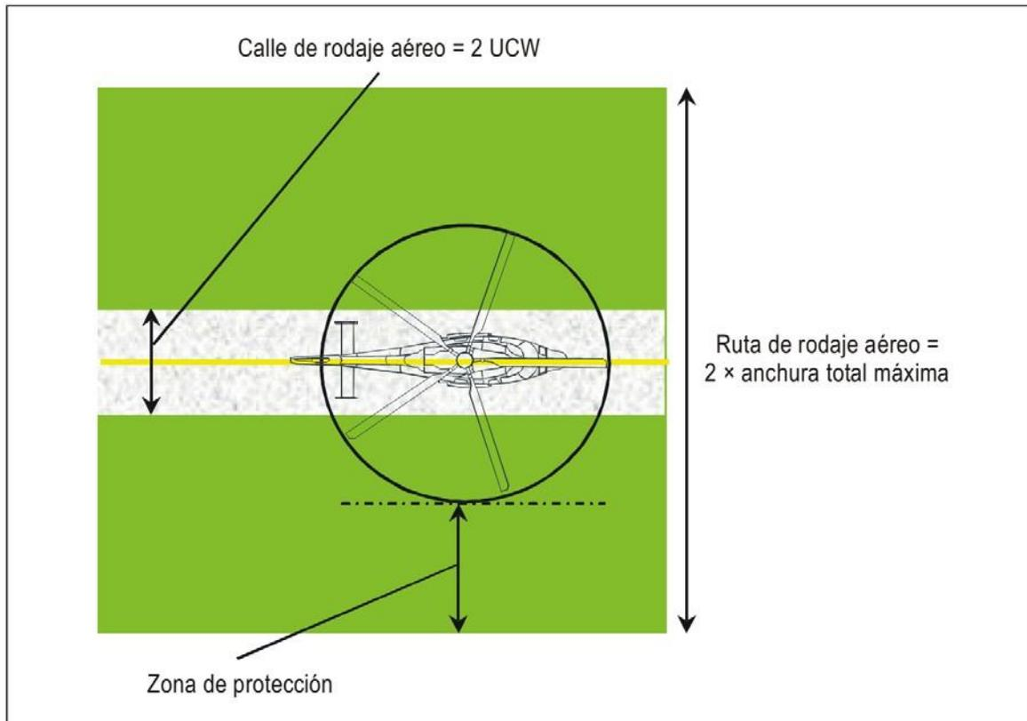
Figura A3-3. Ruta / calle de rodaje aérea para helicópteros
