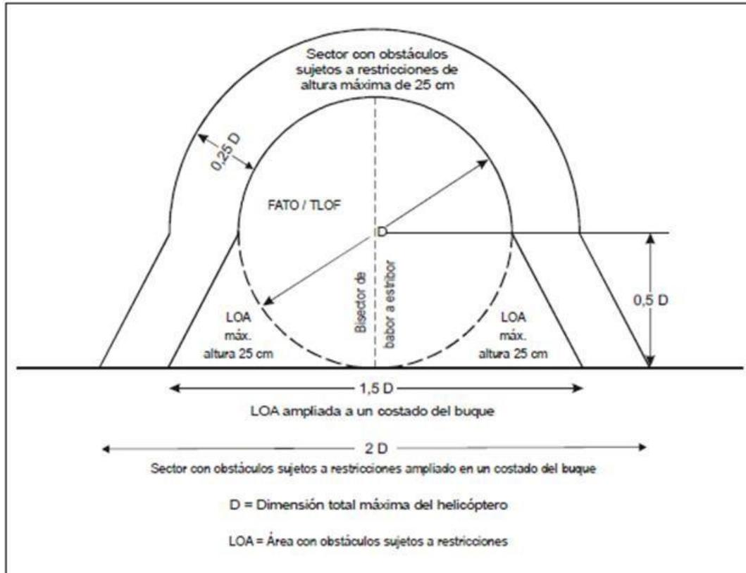
Figura A-4-11. Sectores y superficies limitadoras de obstáculos en helipuertos no construidos expuestos a un costado del buque
