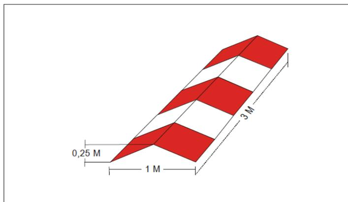
Figura A-5-6. Baliza de borde de FATO de tipo pista de aterrizaje
