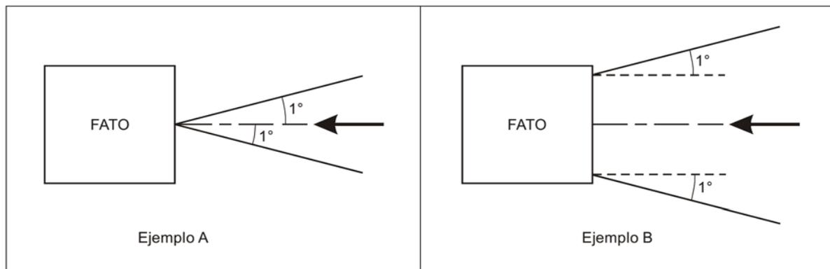
Figura A-5-16. Divergencia del sector “derrota correcta”
