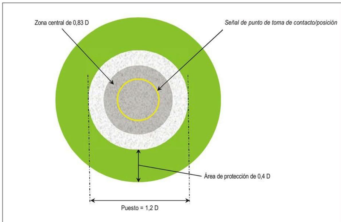
Figura A3-4. Puesto de estacionamiento de helicópteros y zona de protección conexas
