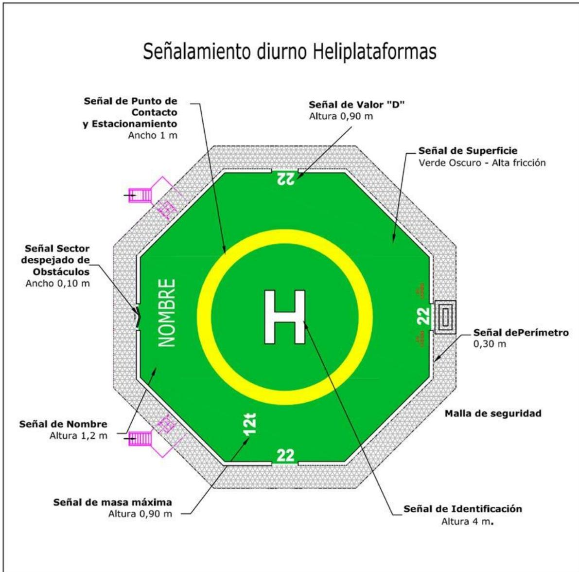
Figura A-5-8. Señalamiento de heliplataforma
