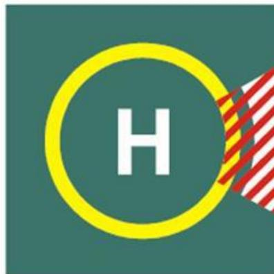
Figura A-5-10. Señal de sector de aterrizaje prohibido en la heliplatforma
