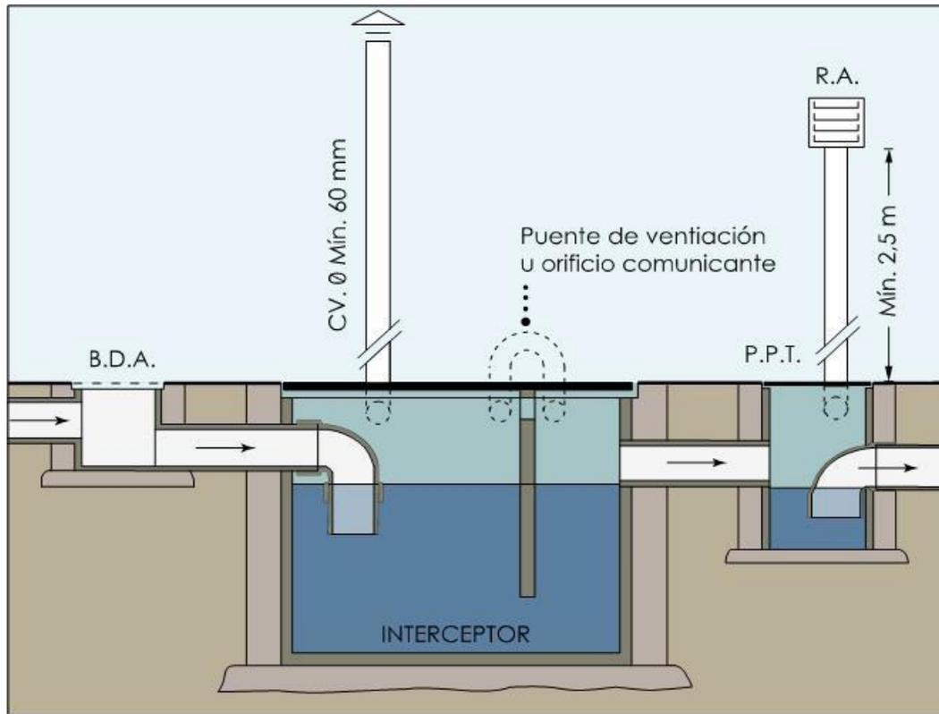
Figura A-3-7. Interceptor de combustible típico
