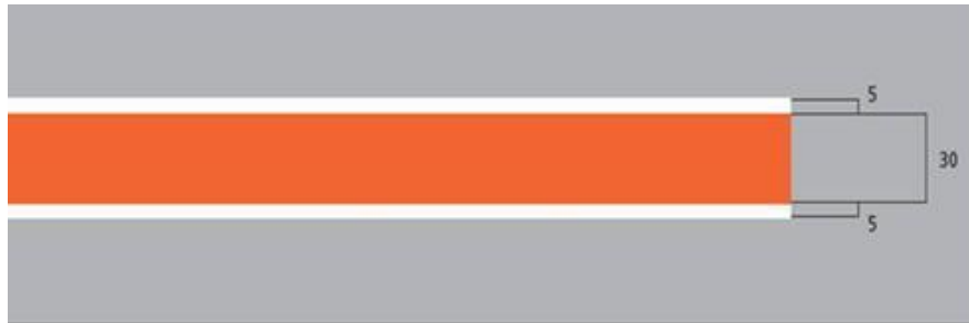
Figura 2-4-1. Línea de seguridad en plataforma ABL
