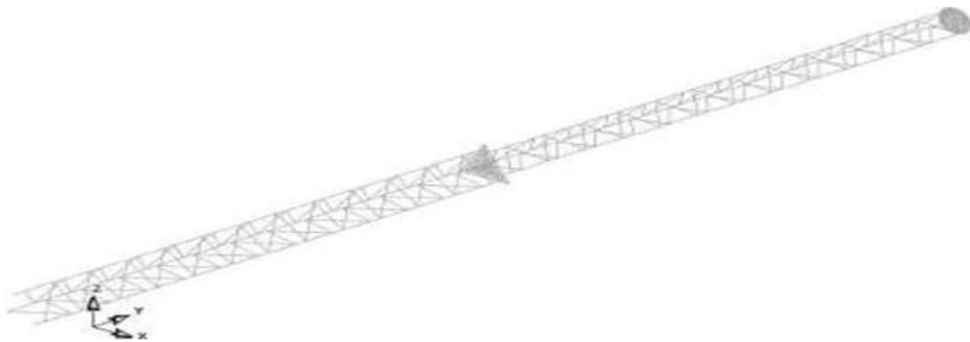
b) Torre de iluminación de aproximación — estructura reticular de aluminio
