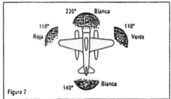
Las luces descritas en a), b) y c) deberían ser visibles a una distancia de por lo menos 3,7 km (2 NM). La luz descrita en d) debería ser visible a 9,3 km (5 NM) cuando se fije a un avión de 20 m o más de longitud, o visible a una distancia de 5,6 km (3 NM) cuando se fije a un avión de menos de 20 m de longitud.
