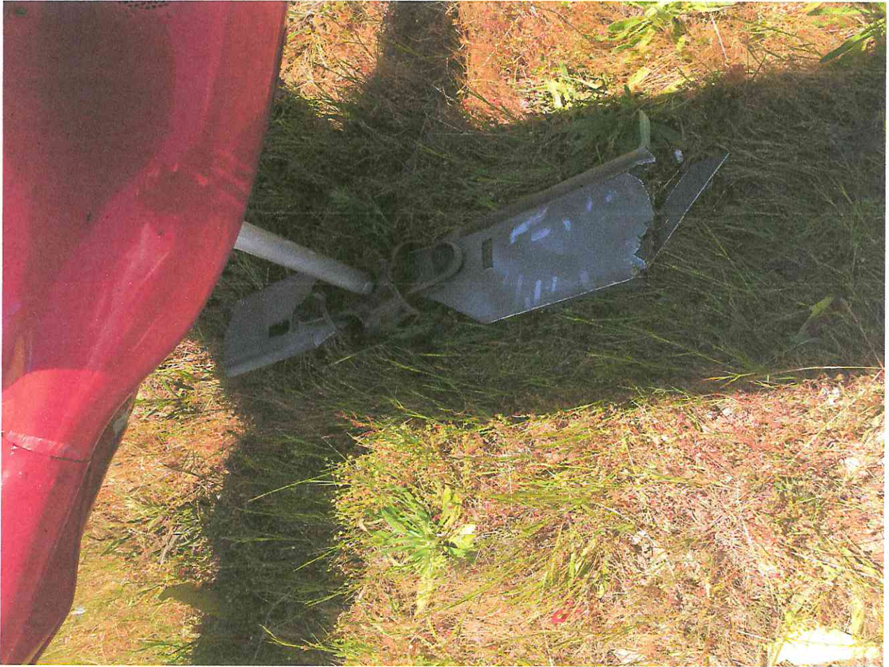
FOTOGRAFÍA N°4. Muestra el daño las palas del rotor de cola.
