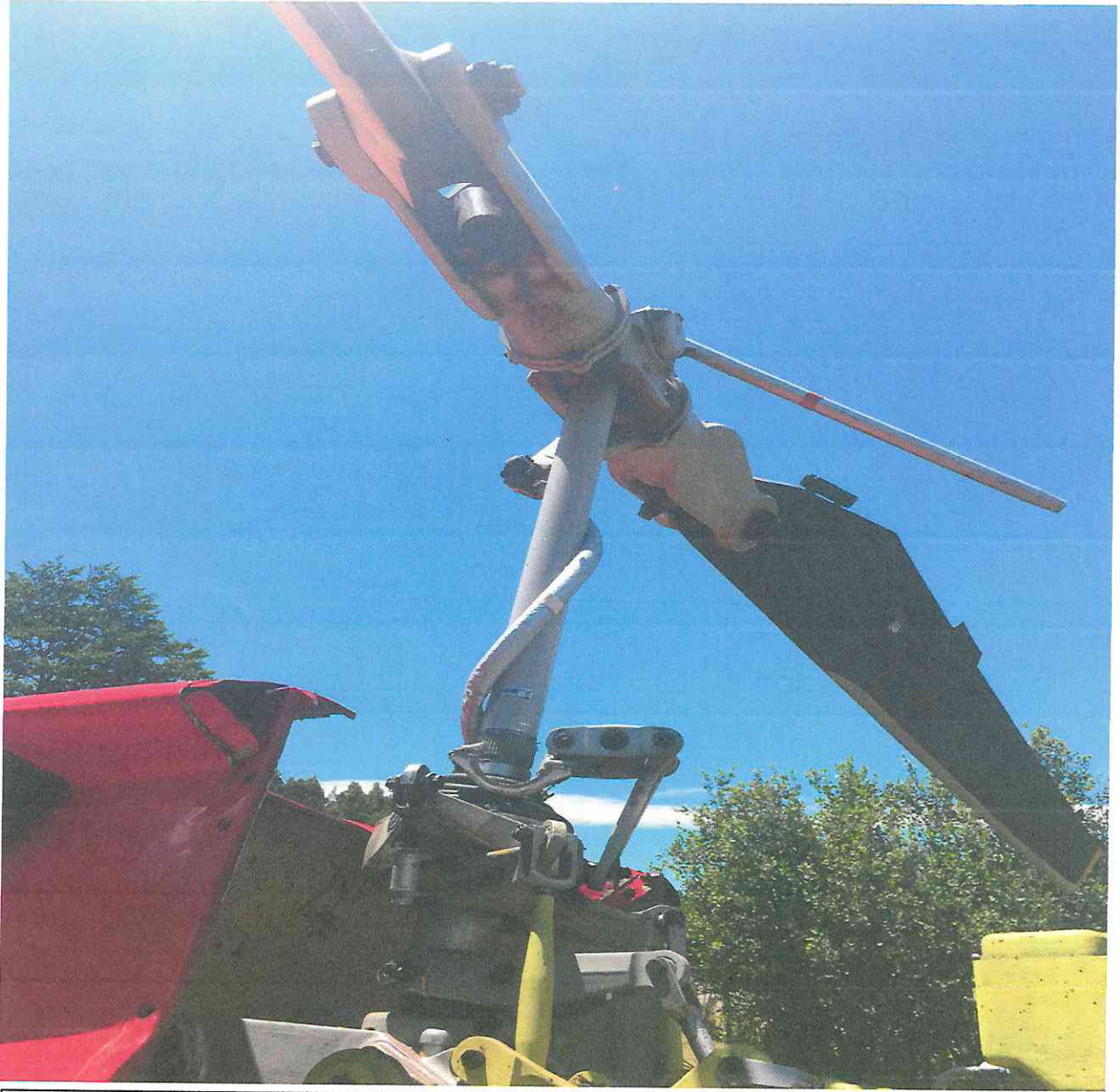
FOTOGRAFÍA N° 3. Muestra las varillas de cambio de paso del rotor principal y el collar set.
