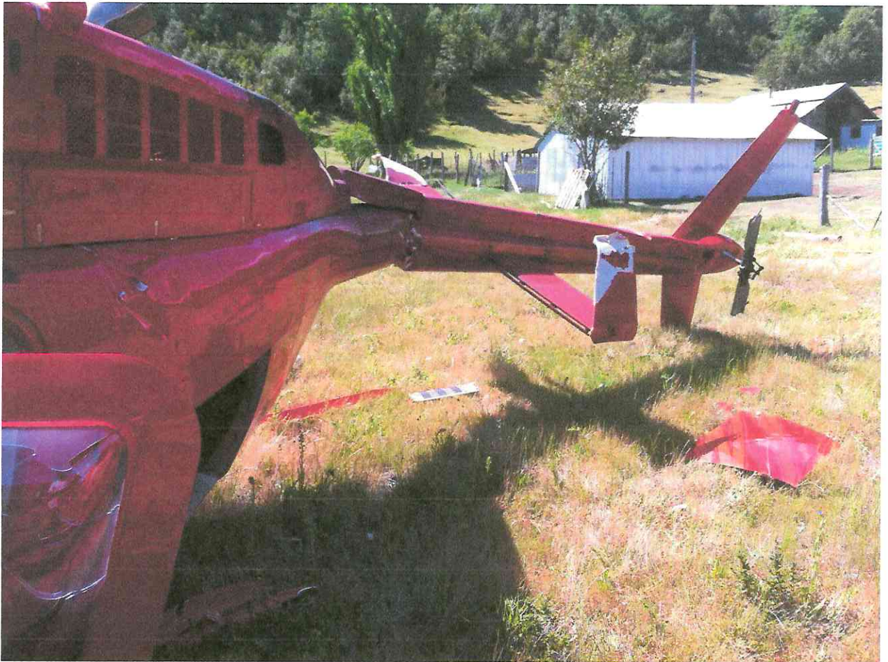
FOTOGRAFÍA N° 2. Muestra el daño el cono de cola y estabilizadores.
