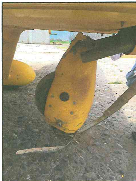
Fotografía N°4: Pierna del tren de aterrizaje de nariz, doblada hacia atrás.
