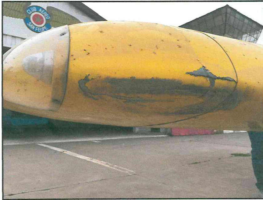
Fotografía N°5: Carenado de punta de ala derecha partido y con signos de roce por arrastre.
