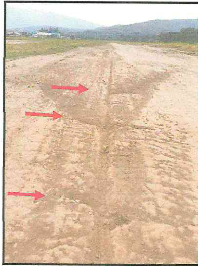
Fotografía N°2: Impactos de la hélice en la pista.
