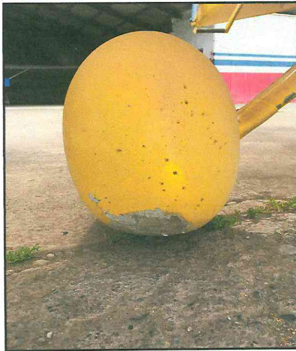
Fotografía N°6: Carenado de rueda derecha del tren de aterrizaje principal, con partiduras y muestras de desgaste.
