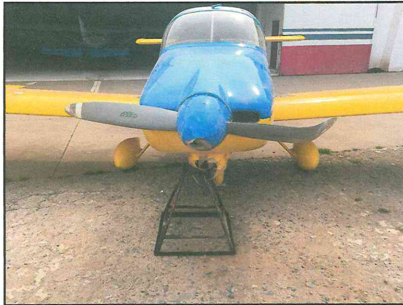
Fotografía N°3: Vista general de la hélice con sus palas y tren de aterrizaje de nariz, ambos con daños.
