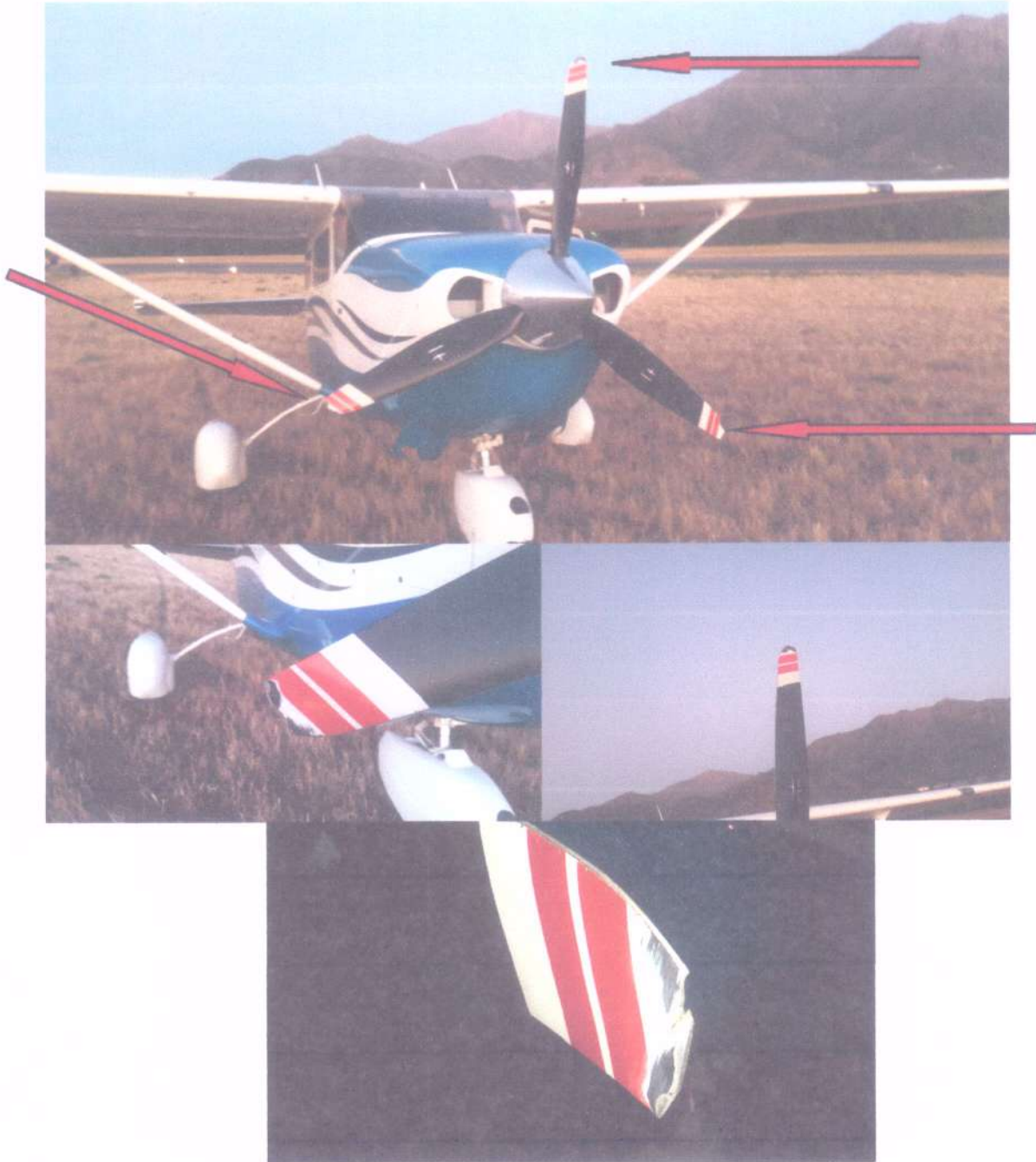
Fotografía N° 2: Vista de la hélice y el daño en sus puntas de palas.
