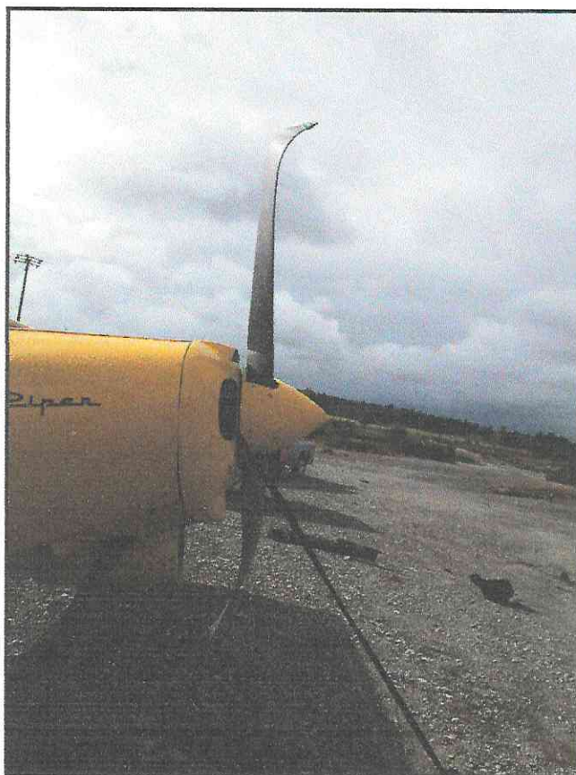
Fotografía N°1: Vista general de la hélice y las deformaciones en las palas.
