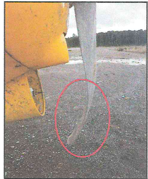
Fotografías 3 y 4: Evidencia de las deformaciones de las puntas de las palas.
