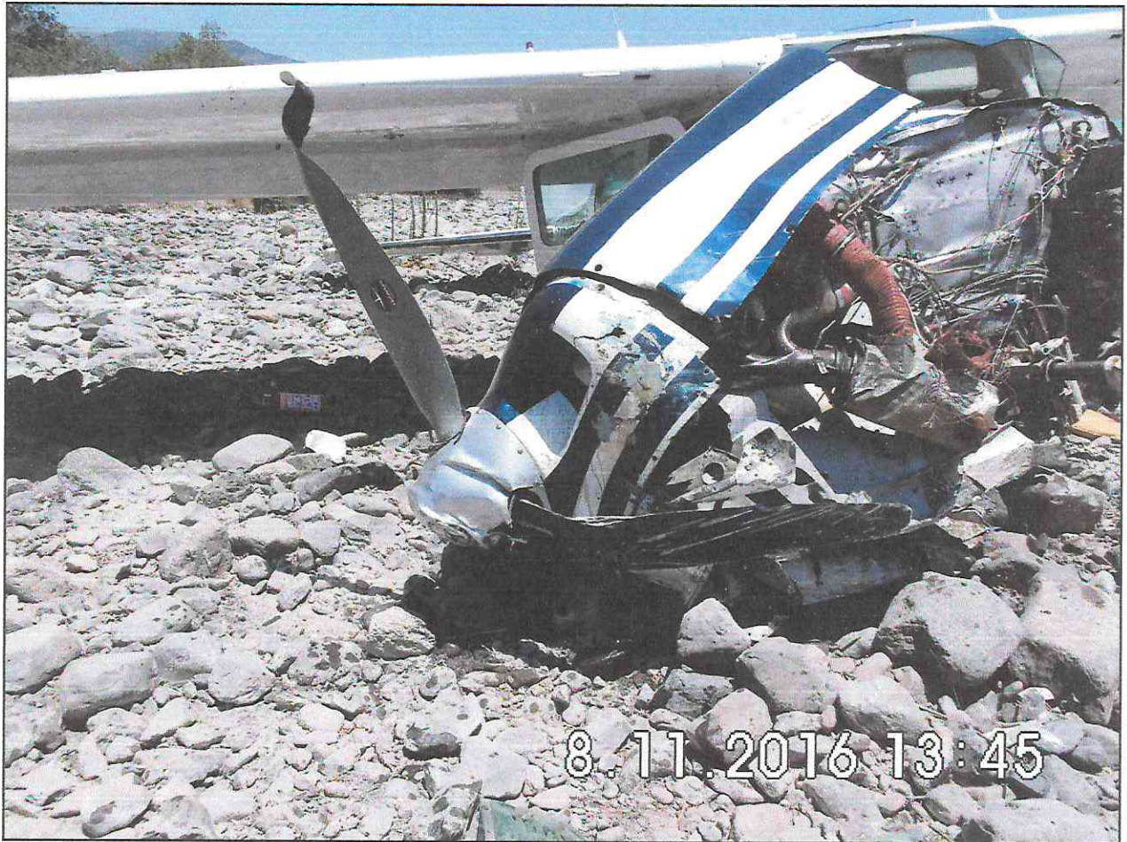
FOTOGRAFÍA N° 04 Daños en la hélice y sus palas.
