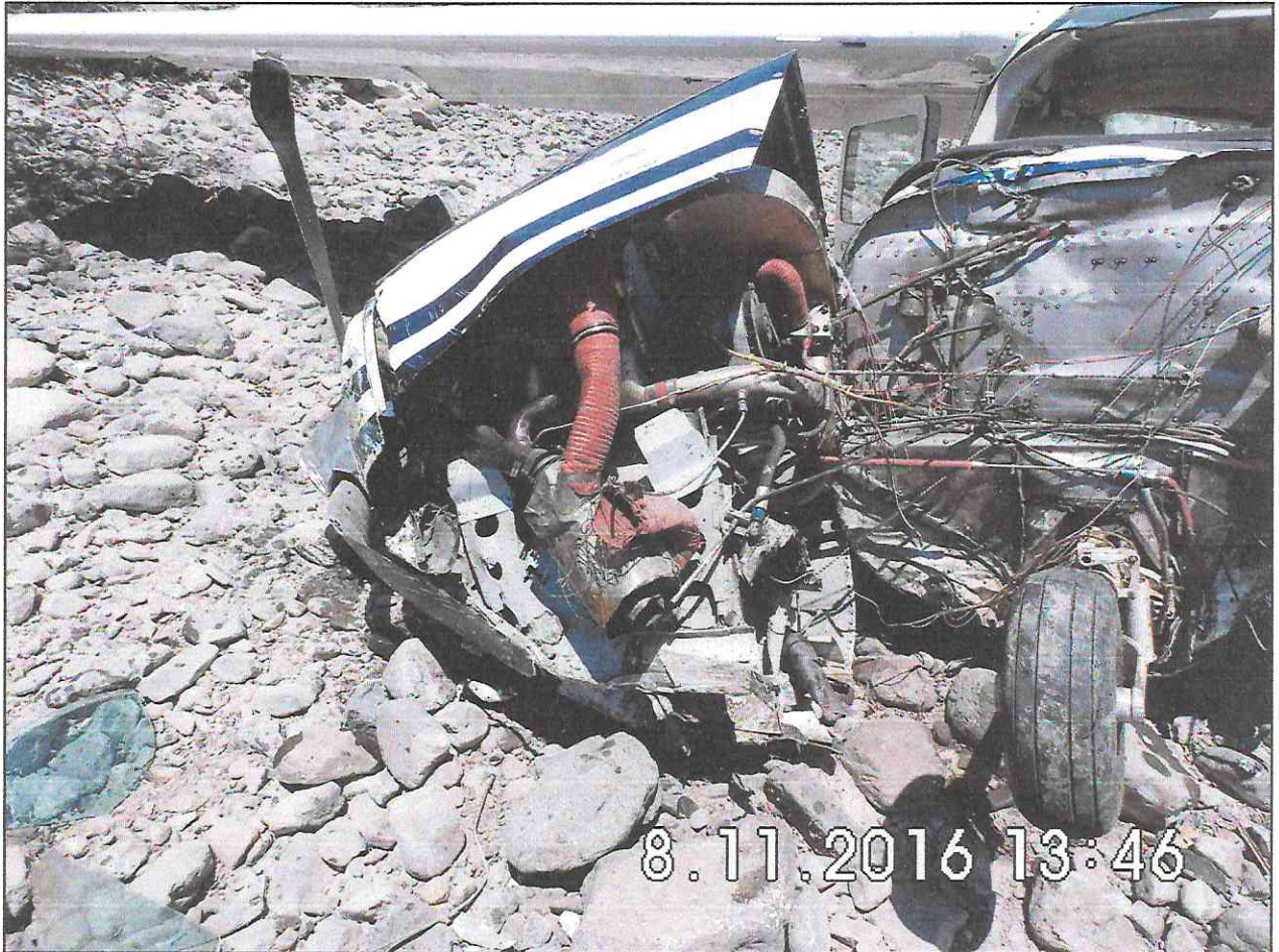
FOTOGRAFÍA N° 03 Daños en la nariz de la aeronave.
