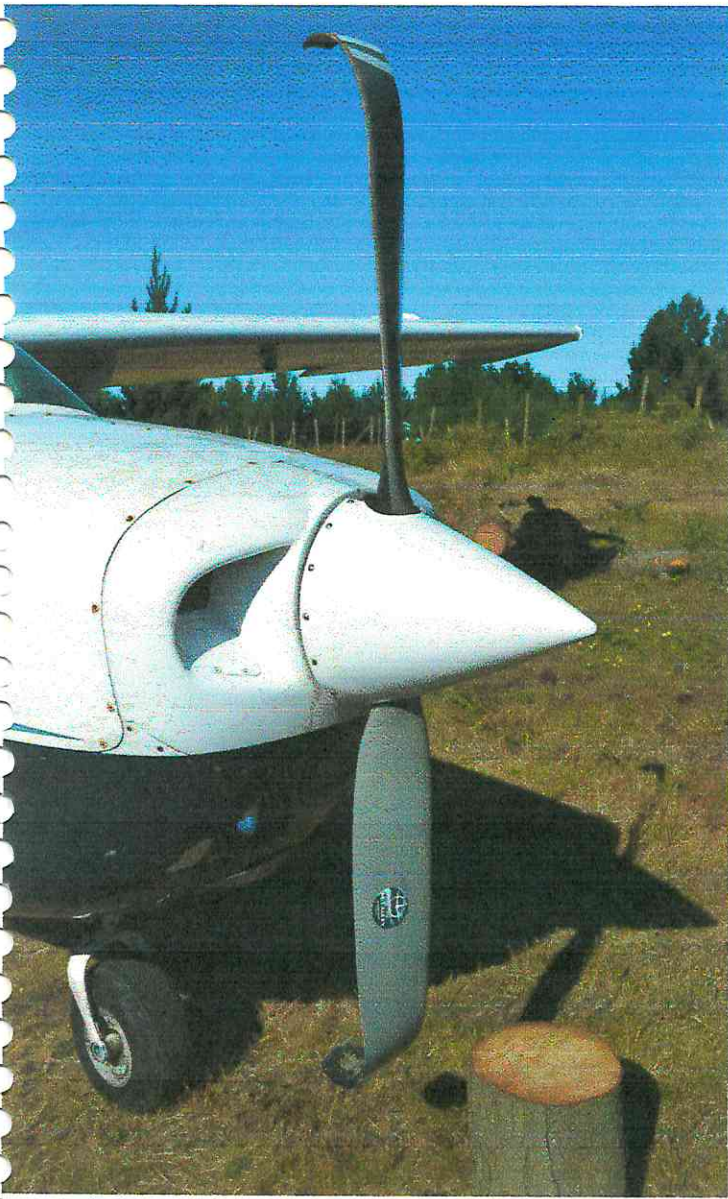
Fotografías N.º 2 y 3: Vista del daño en las hélices frontal y trasera, posterior al suceso en el sector donde fue estacionada.
