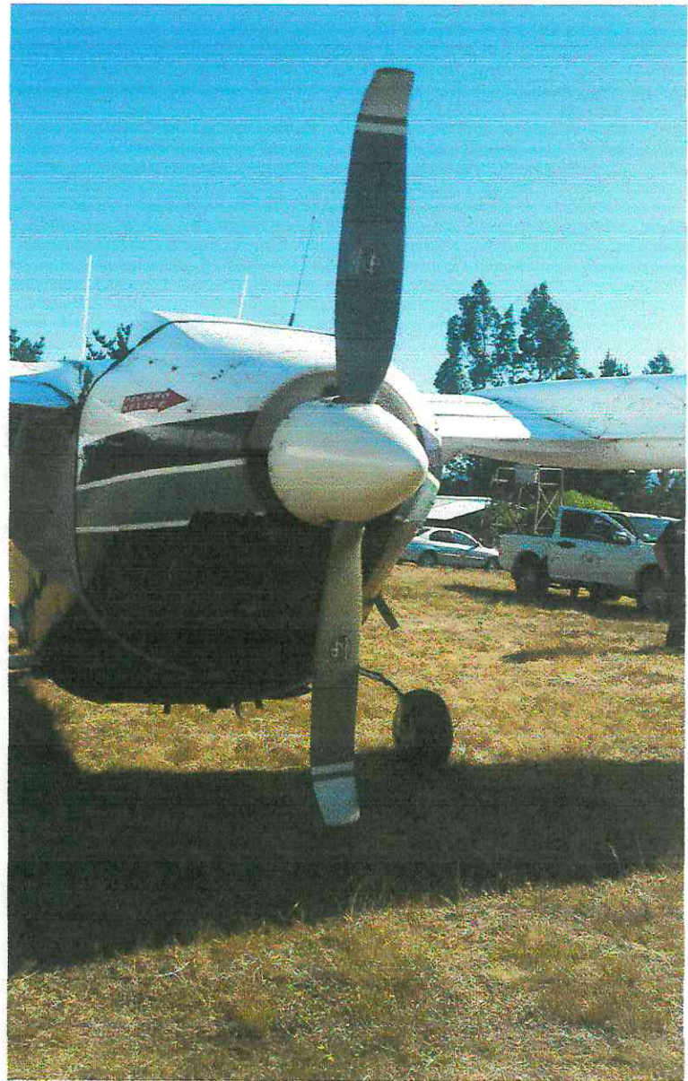
Fotografías N.º 2 y 3: Vista del daño en las hélices frontal y trasera, posterior al suceso en el sector donde fue estacionada.
