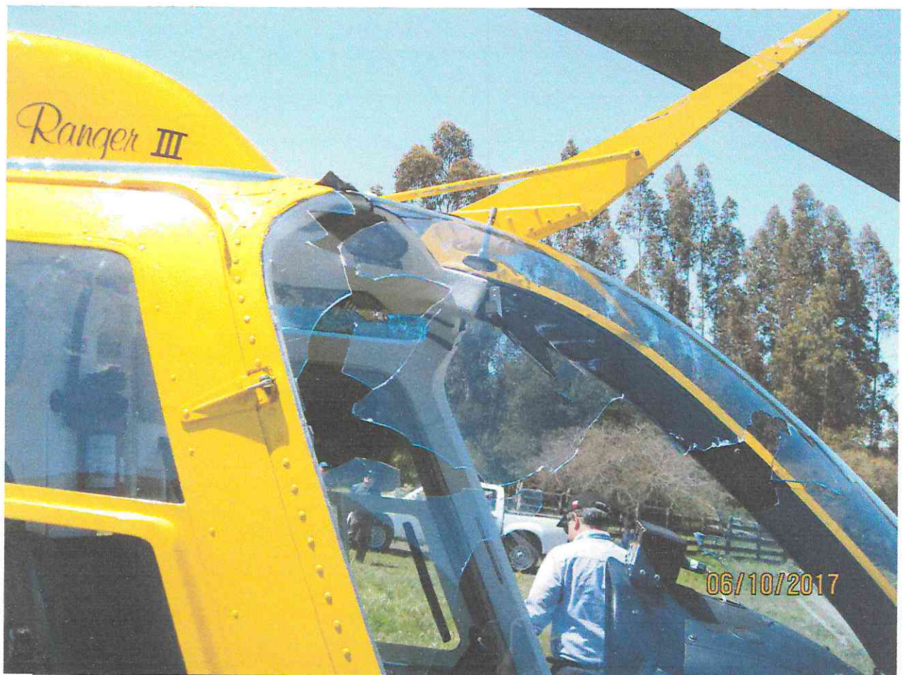
Fotografía N°1 parabrisas del lado del piloto quebrado.
