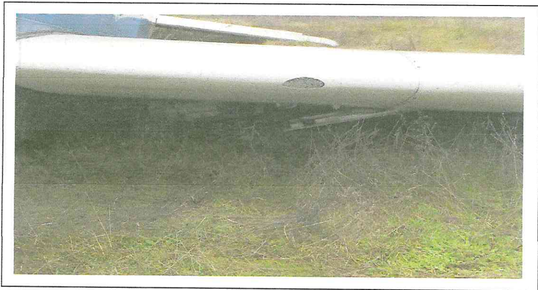
FOTO N° 4 Tren principal izquierdo dañado.
