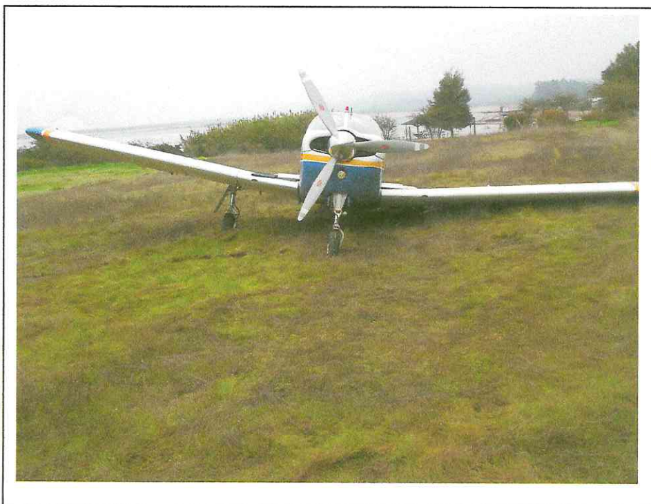
FOTOGRAFÍA N° 1, posición final de la aeronave, destacando la inclinación hacia el lado izquierdo de ella.
