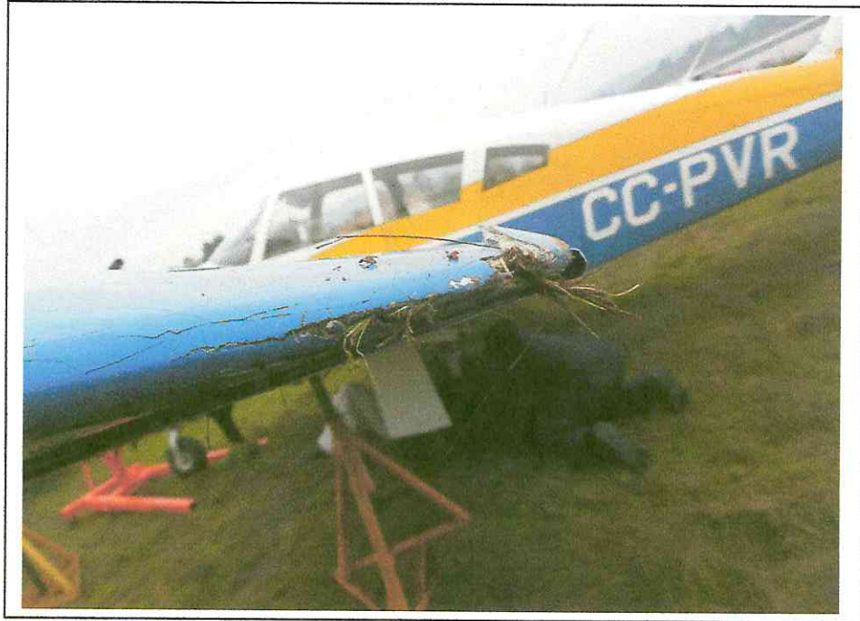
FOTOGRAFÍA N° 5, Vista de los daños en el carenado de la punta de ala izquierda.
