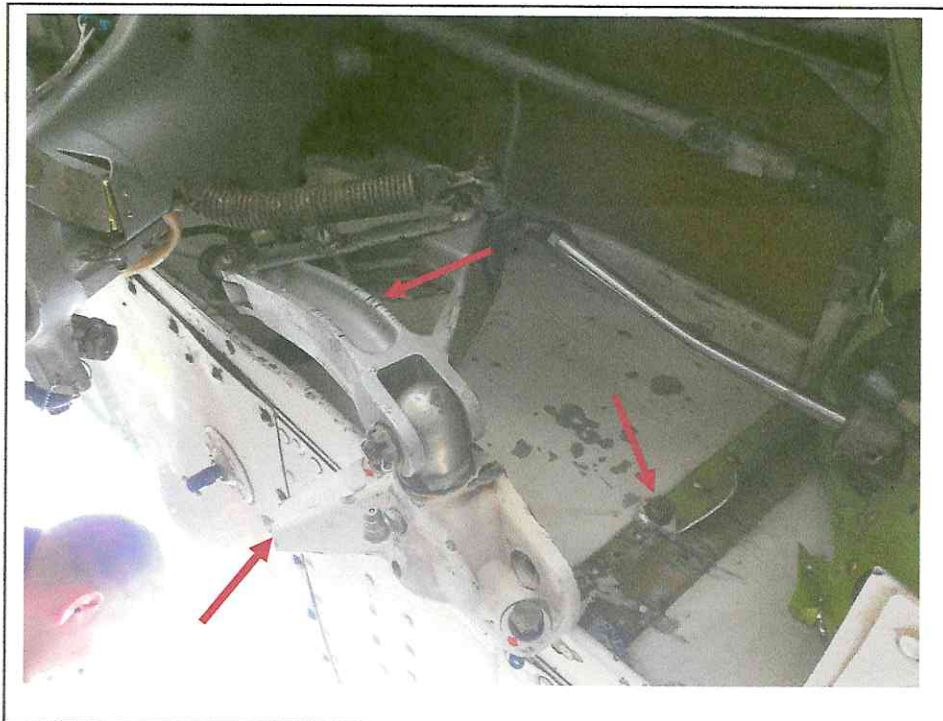
FOTOGRAFÍA N° 4, se distinguen daños en el soporte de barra retracción tren, conjunto viga triangular y resorte seguro abajo tren.
