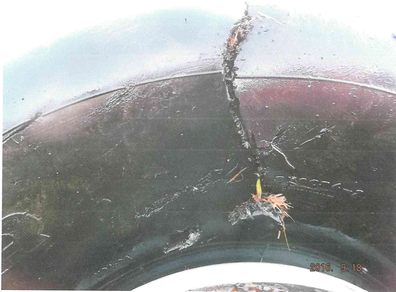
FOTOGRAFÍA N° 1. Muestra la rueda del tren de aterrizaje derecho con su neumático reventado.
