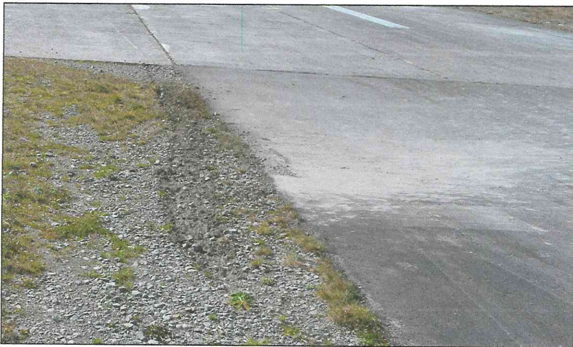
FOTOGRAFÍA 08 Primera huella de contacto dejada por la rueda del tren de aterrizaje derecho.
