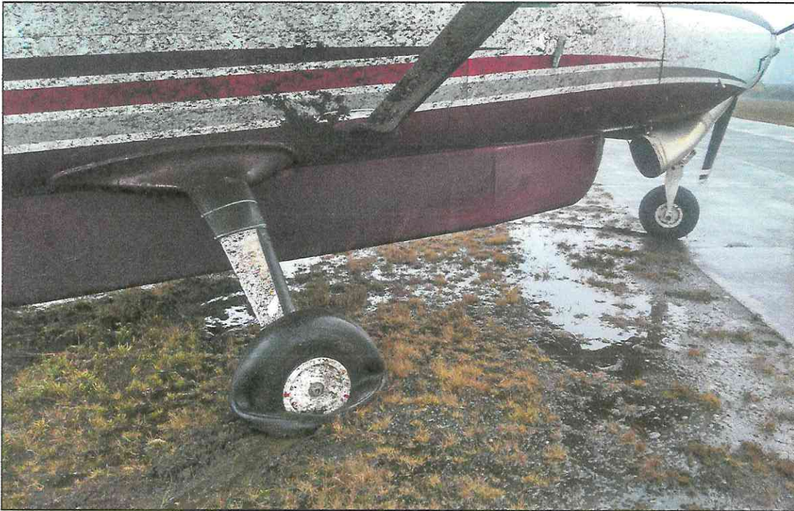
FOTOGRAFÍA 17 Posición final de la aeronave y daños en la rueda derecha del tren principal de aterrizaje.
