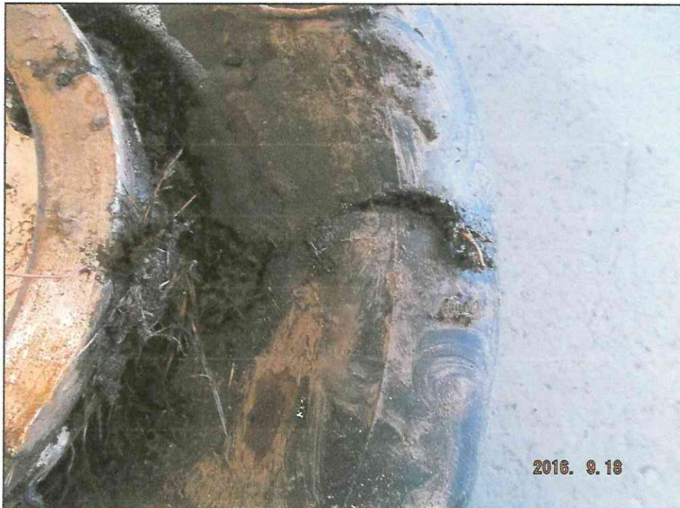
FOTOGRAFÍA 17 Daños en la rueda derecha del tren principal de aterrizaje.
