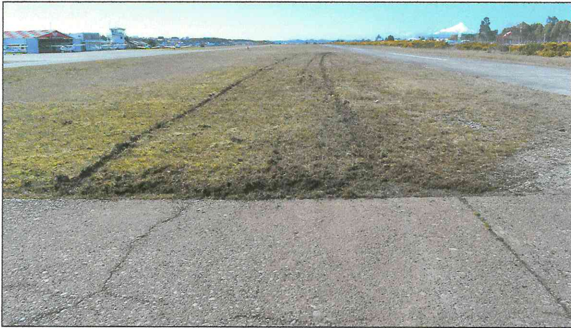
FOTOGRAFÍA 13 Huella del tren de aterrizaje, durante la carrera de aterrizaje, después de cruzar la calle de rodaje Delta.
