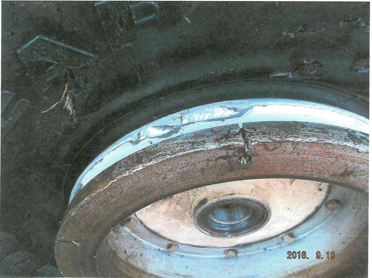
FOTOGRAFÍA N° 2. Muestra el daño en la masa y disco de freno de la rueda derecha del tren de aterrizaje principal.
