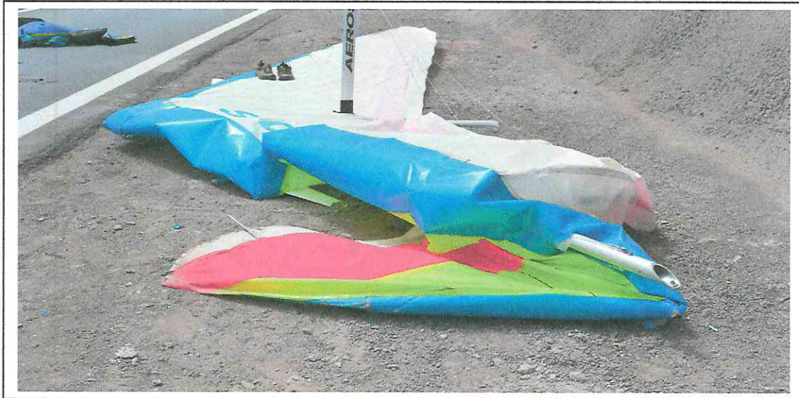
Fotografía superior muestra en Ala Delta dañada, foto inferior muestra borde de ataque del parapente, dañada.
