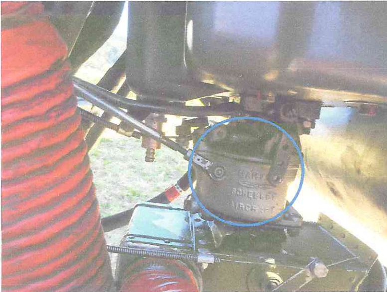
Fotografía N°1: Vista de desconexión entre acelerador y carburador.
