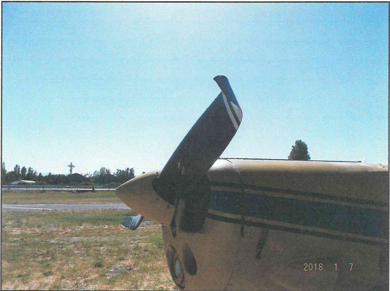
FOTOGRAFÍA N° 1: Muestra el daño en las palas de la hélice.
