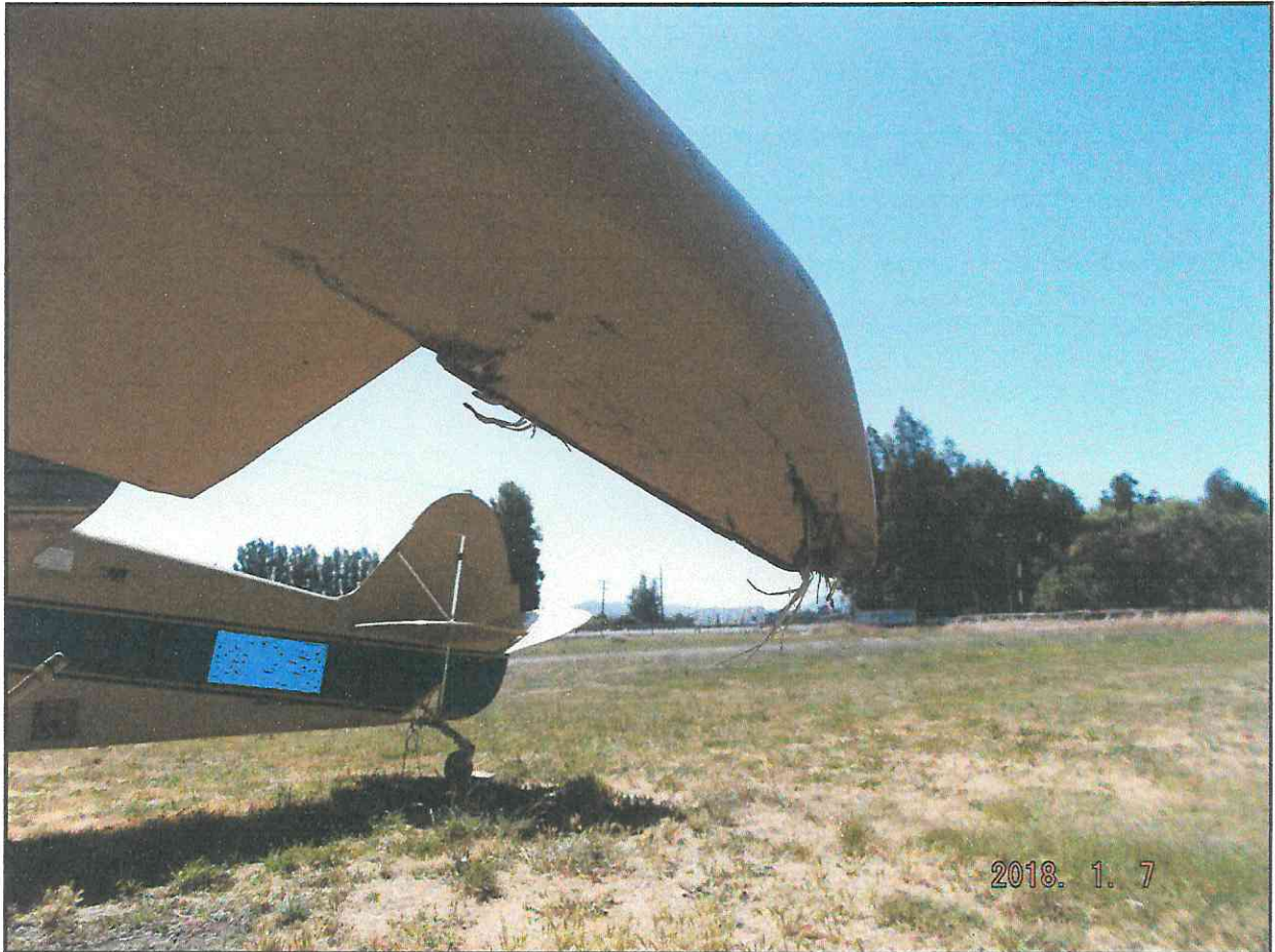
FOTOGRAFÍA N° 2: Daño en la punta del ala izquierda.
