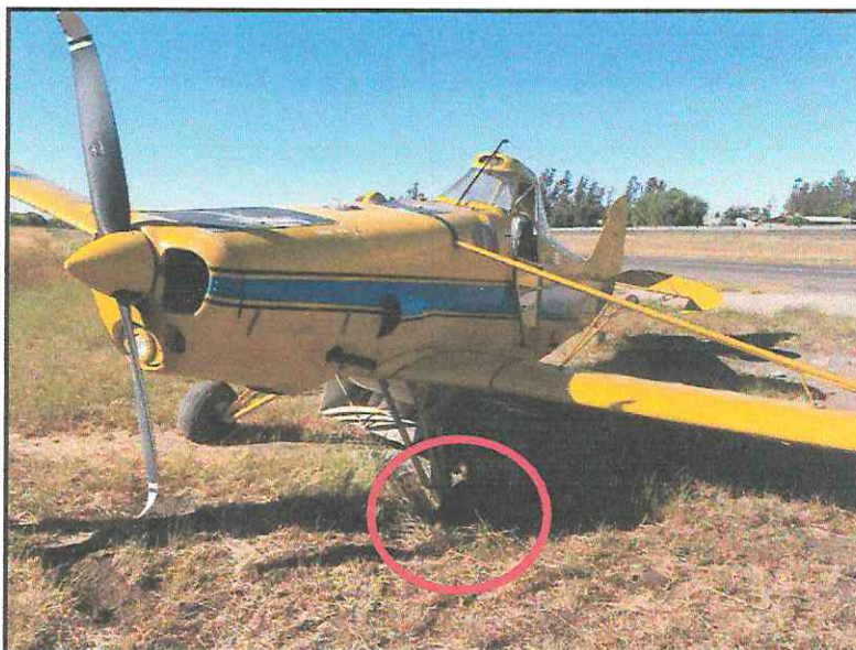
Fotografía 1: Rueda izquierda al interior de un hoyo del terreno.
