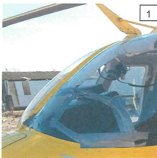
Fotografías N° 1, 2, 3 y 4: Vistas de daños y del sistema cortacables.
