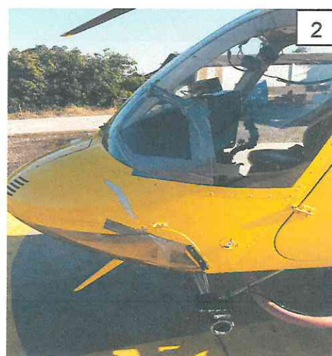
Fotografías N° 1, 2, 3 y 4: Vistas de daños y del sistema cortacables.
