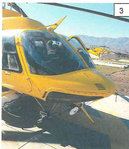
Fotografías N° 1, 2, 3 y 4: Vistas de daños y del sistema cortacables.
