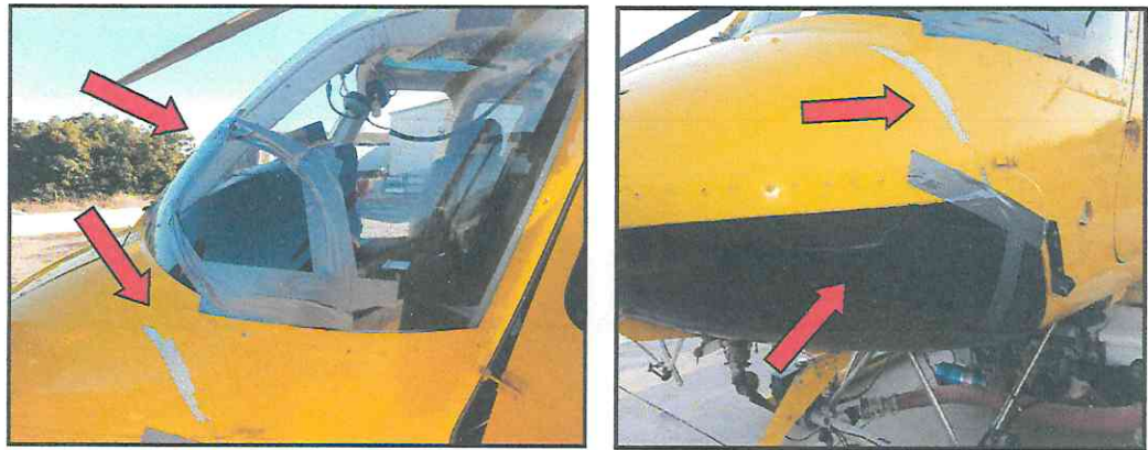
Fotografías 1 y 2: Daños en el parabrisas del costado izquierdo.
