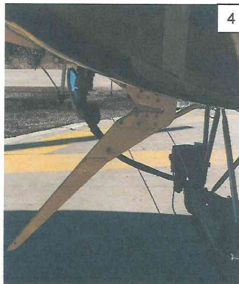
Fotografías N° 1, 2, 3 y 4: Vistas de daños y del sistema cortacables.
