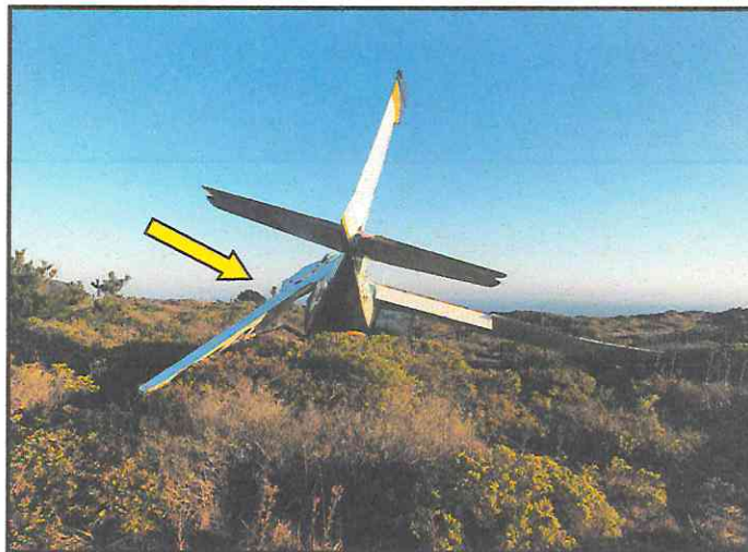
Fotografía 4: Daño en el ala izquierda.
