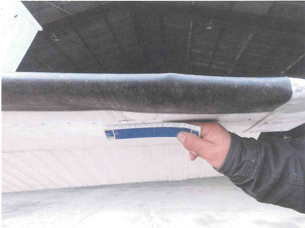
2. Estabilizador horizontal, con evidencia de marcas por arrastre de ramas de árboles.
