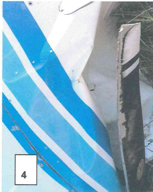
Foto N° 4.- Marcas de giro con potencia y pérdida de material.
