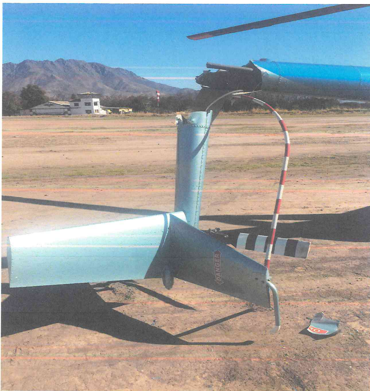
FOTOGRAFÍA N°2. Muestra el cono de cola, el que estaba cortado.
