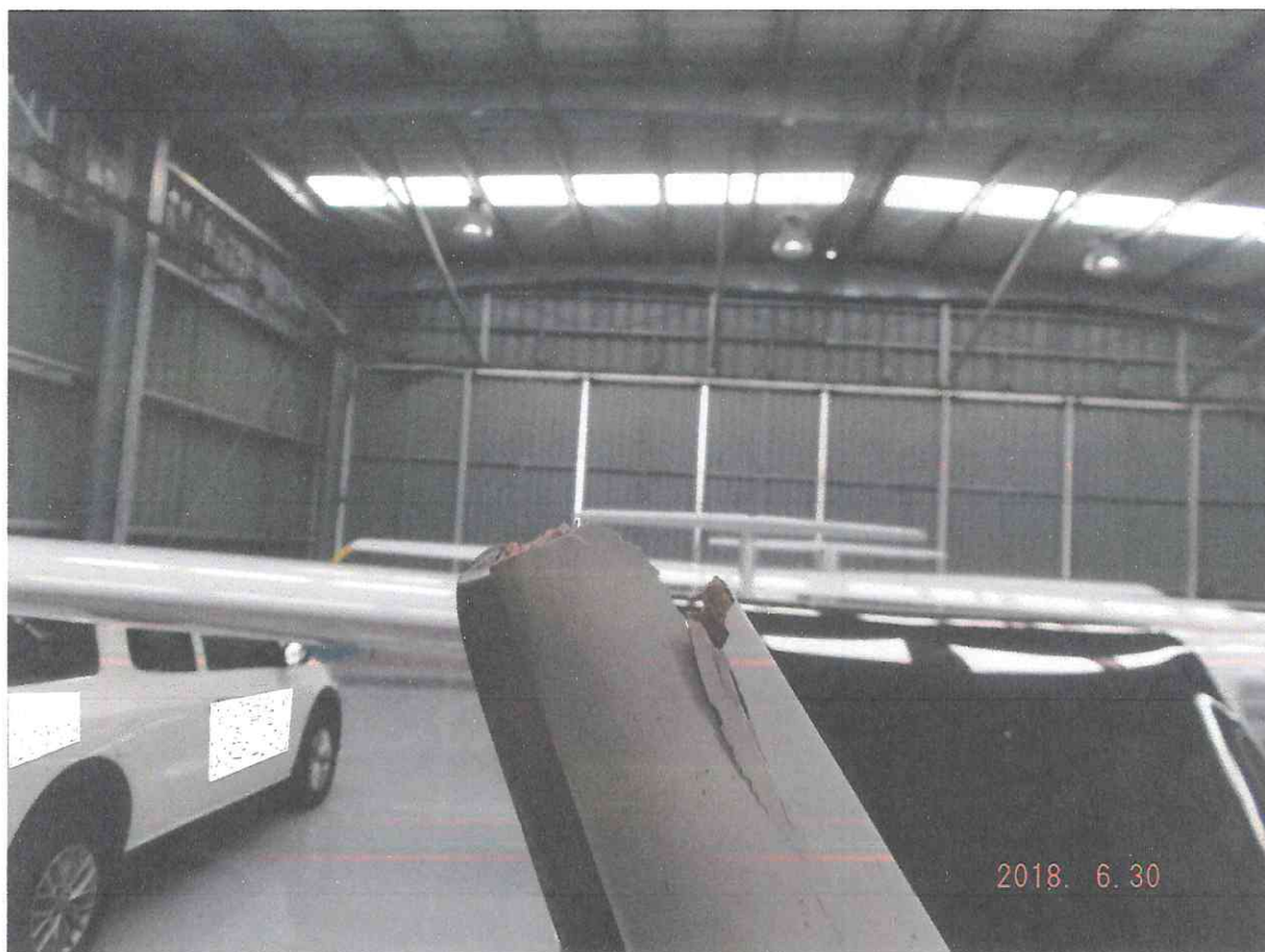
FOTOGRAFÍA N° 3. Muestra el daño en una de las palas de la hélice, con una fractura de 15 cm. y pérdida de material de unos 5 cm. en su extremo.
