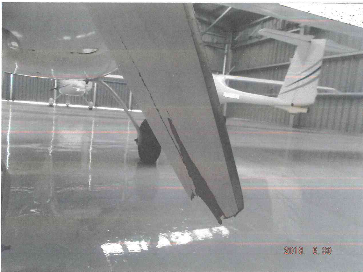
FOTOGRAFÍA N° 2. Muestra el daño en una de las palas de la hélice, con una fractura de 35 cm. y pérdida de material de unos 10 cm. en su extremo.
