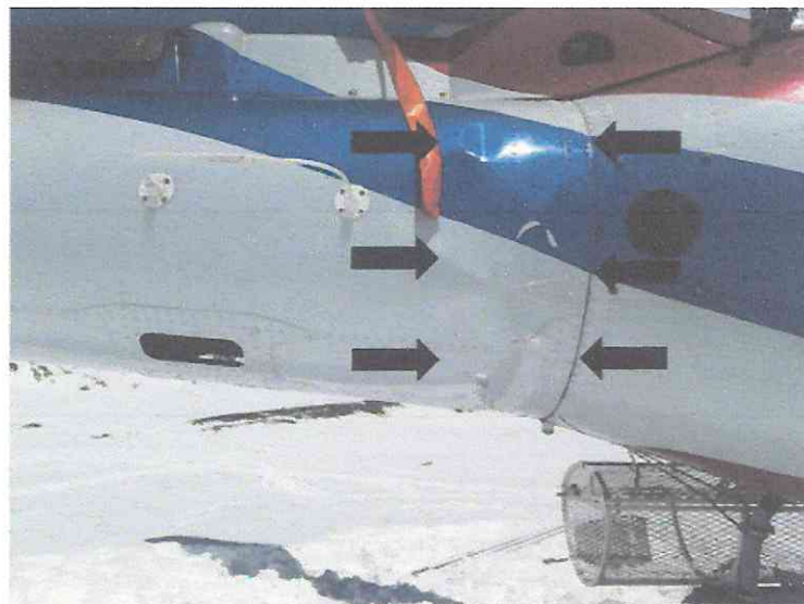
Fotografía n° 4. Vista lateral derecha, con detalles de las deformaciones en el cono de cola.
