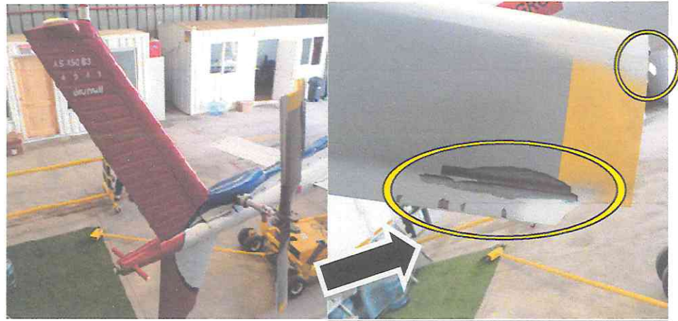
Fotografías n°ros. 2 y 3. Daños en una de las palas del rotor de cola.
