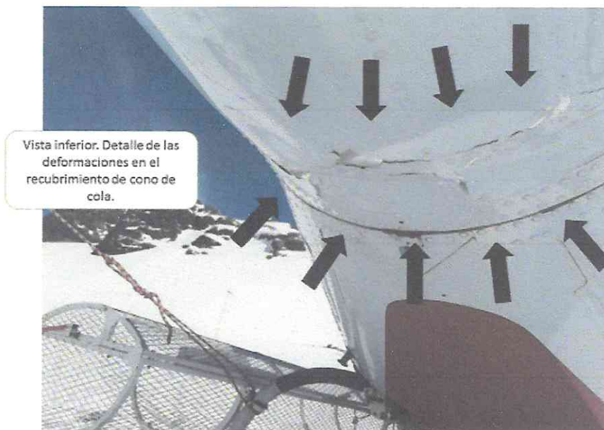
Fotografía n° 5. Vista inferior con detalles de las deformaciones en el cono de cola.
