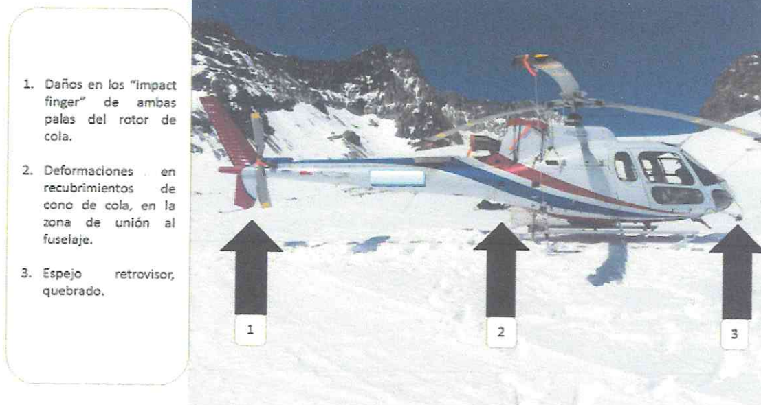
Fotografía N°1. Vista lateral derecha, con zonas dañadas.
