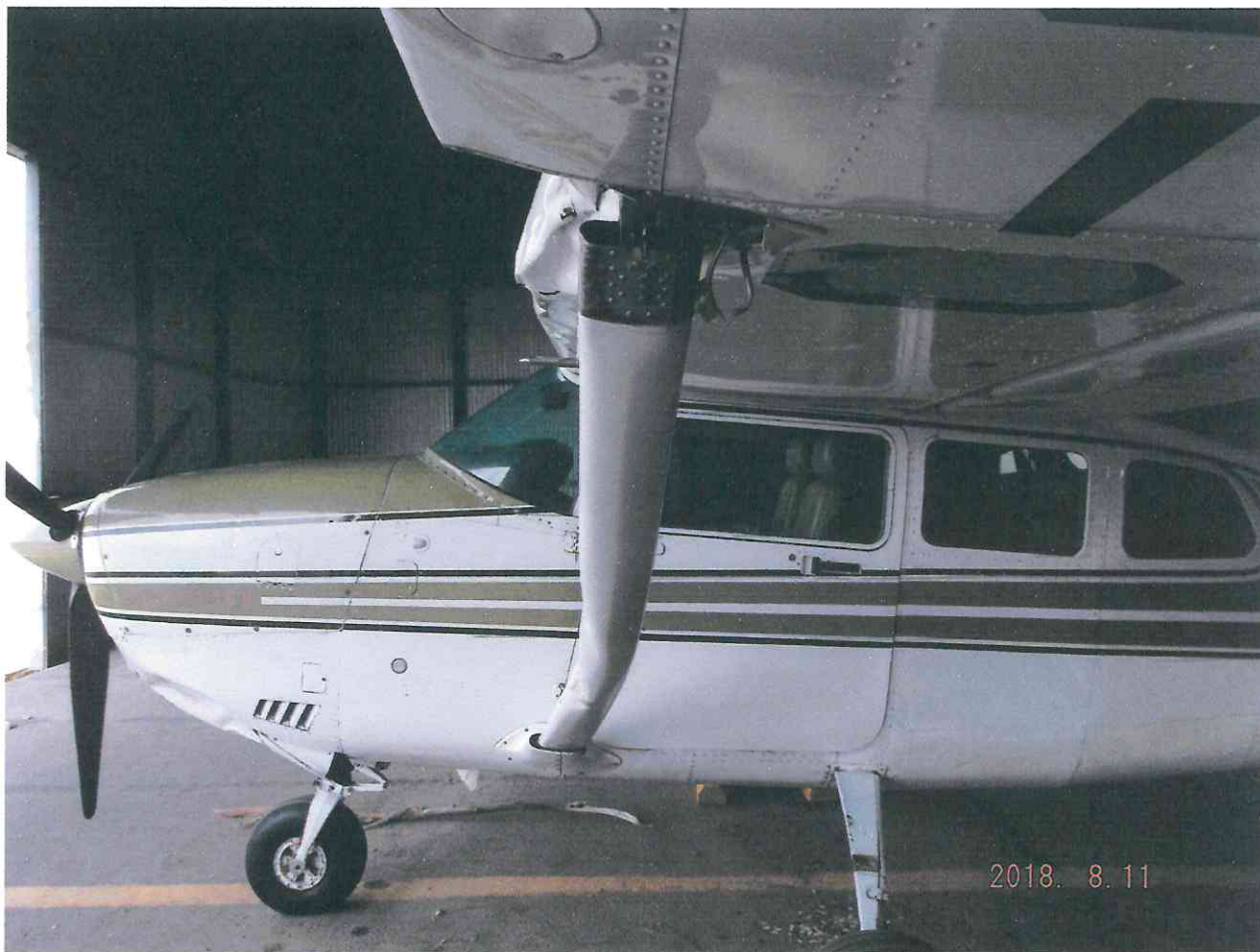
FOTOGRAFÍA N° 3. Muestra el daño en el montante del ala izquierda.
