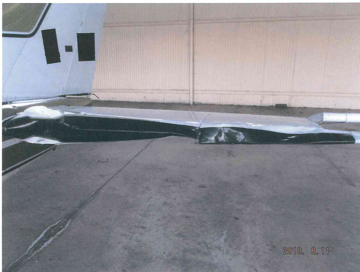
FOTOGRAFÍA N° 4. Muestra el daño en el borde de ataque del estabilizador horizontal izquierdo, esto se repite al lado derecho.
