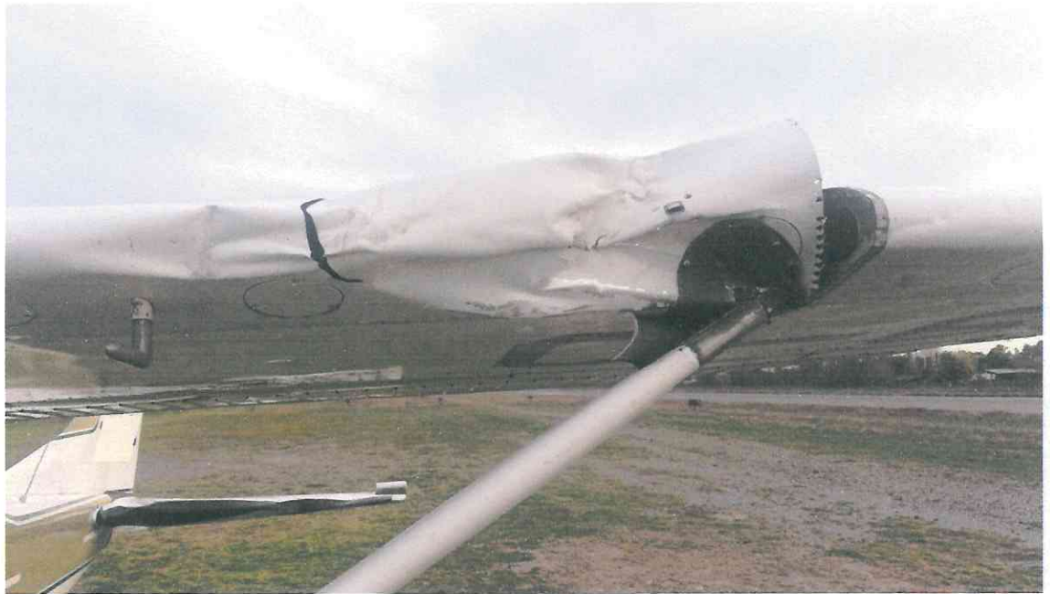
Imagen 3. Acercamiento de la zona del tubo pitot y sistema de alarma de pérdida.
