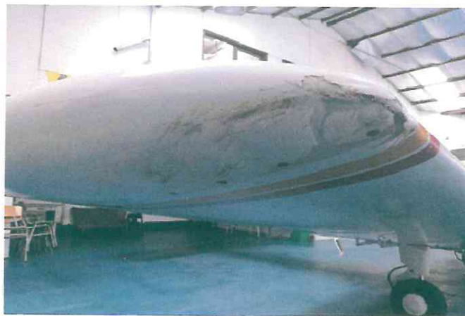
Fotografía N° 2. Fracturas en el carenado de punta de ala derecha.
