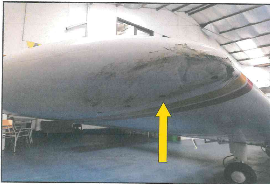
Fotografía 5: Daños en el extremo del ala derecha.
