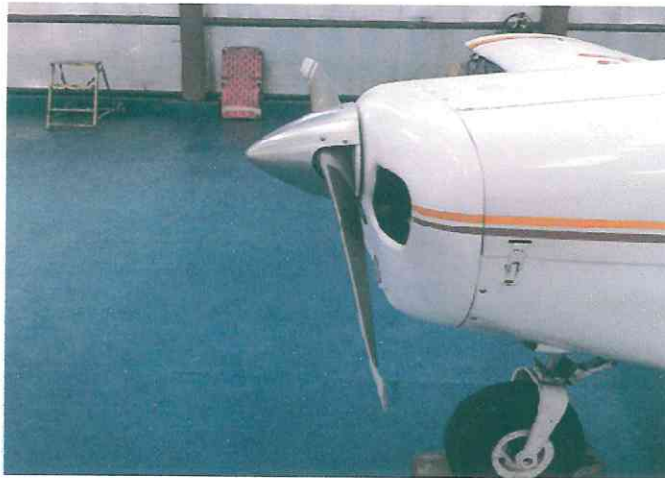
Fotografía N° 1. Daños en las puntas de las palas de la hélice.
