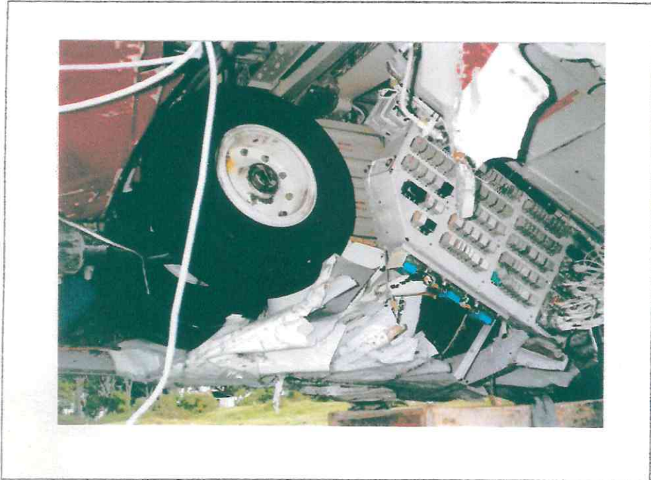
Conjunto del tren de aterrizaje de nariz, el cual después del impacto quedó alojado en el compartimiento eléctrico/electrónico.
