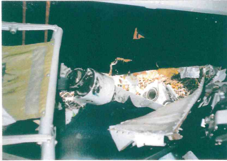
Vista desde el interior de la cabina de pasajeros, en donde el conjunto del Main fitting superior del tren rompió el fuselaje en aproximadamente 1 metro de largo por 30 cms. de ancho.
