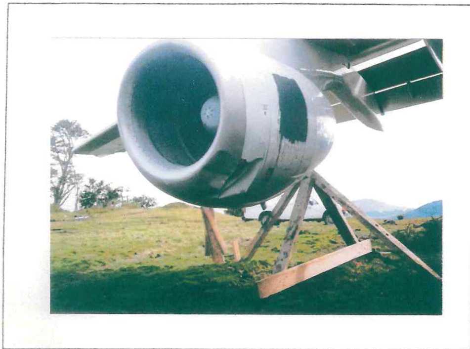
Motor N° 4, capota de admisión abollada.
