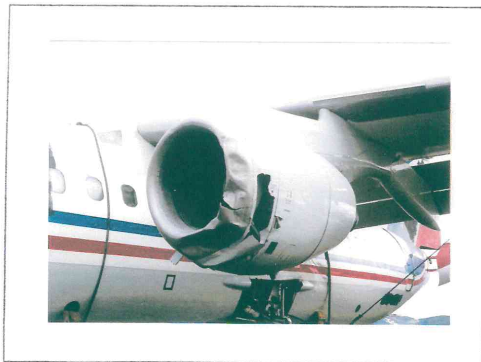
Motor N° 2, capota de admisión abollada y deformada.
