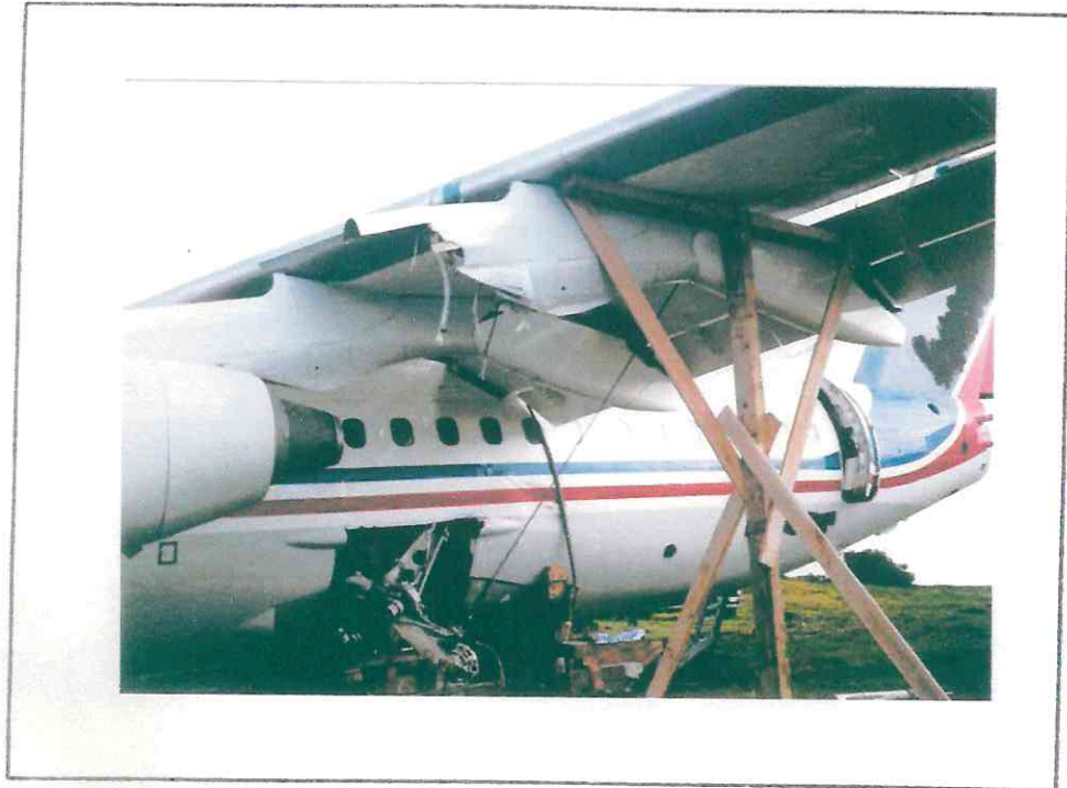
Desde la estación 312.5 hasta la estación 755,5 la base del fuselaje está abollada en toda su extensión.
