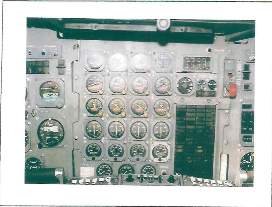
Panel central, instrumentos de motores y otros indicadores.
