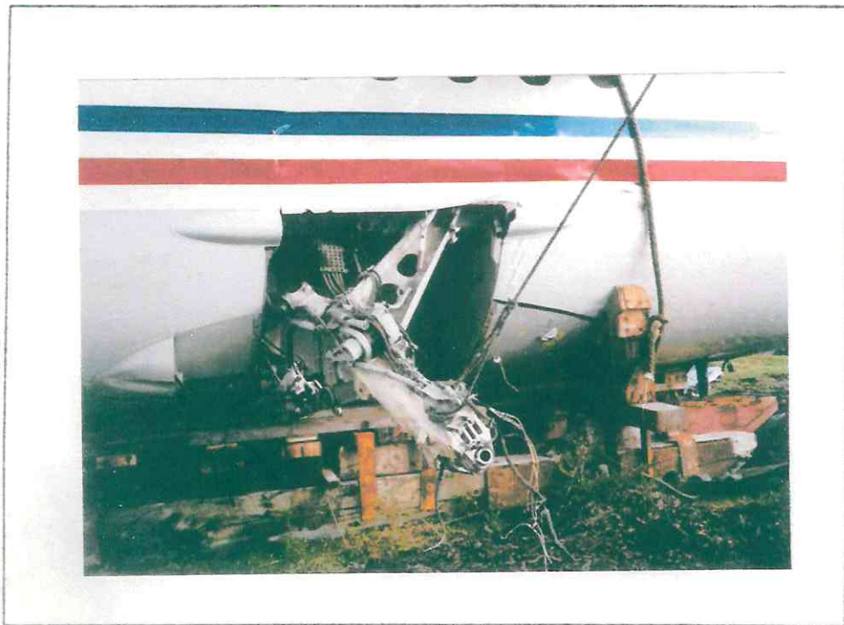
Vista general del conjunto del tren principal izquierdo, en donde se puede apreciar que parte del Main fitting superior está desplazado al interior del fuselaje.
