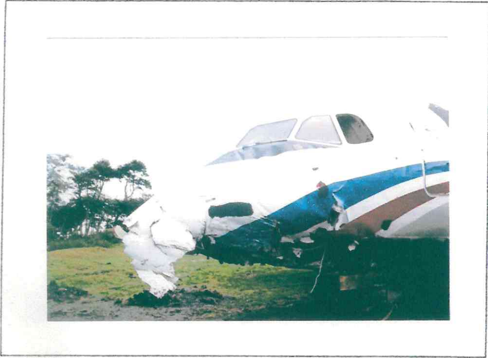
Zona desde el rãdomo hasta ventanillas de escape de la tripulaci3n, arrugada y deformada.
