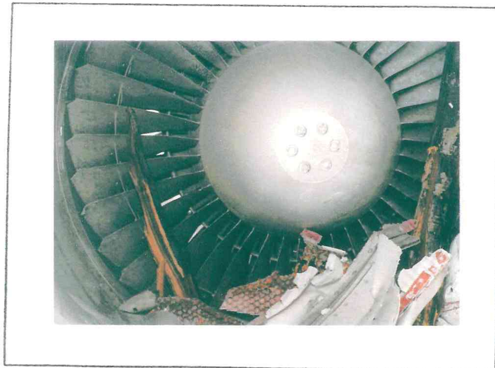
Sección del compresor del motor N° 1, con daños en las puntas de los álabes.
