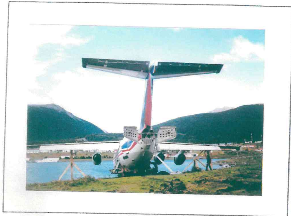
Vista general del empenaje, elevadores y compensadores.
