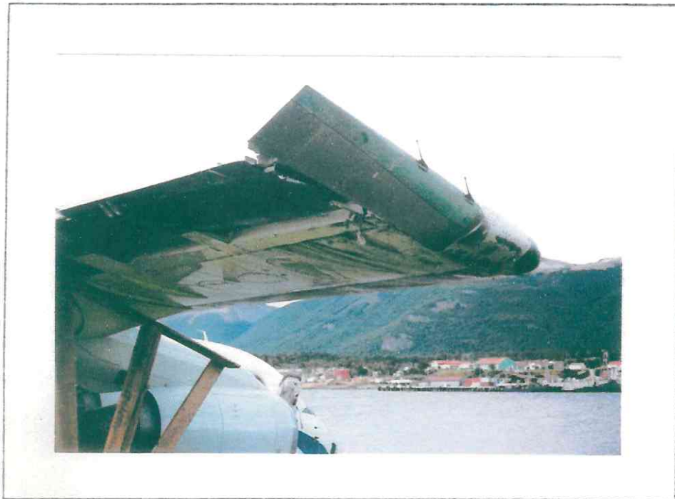
Condición de punta de ala derecha y su alerón.
