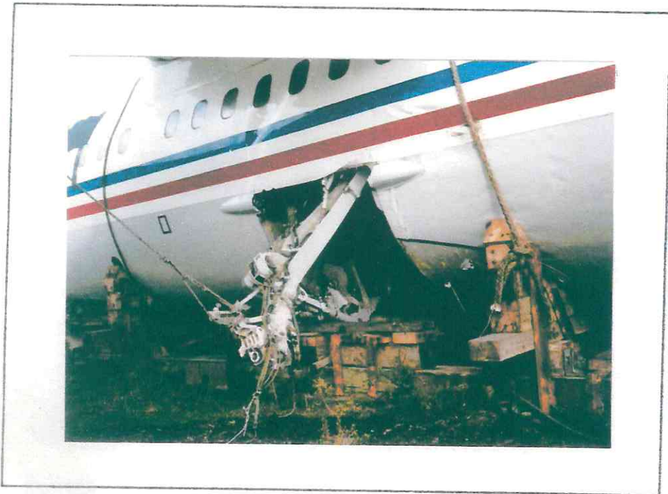
Conjunto del tren de aterrizaje izquierdo en donde el main fitting superior está cortado y separado del main fitting inferior, además, se produjo el desprendimiento del shock absorber.
