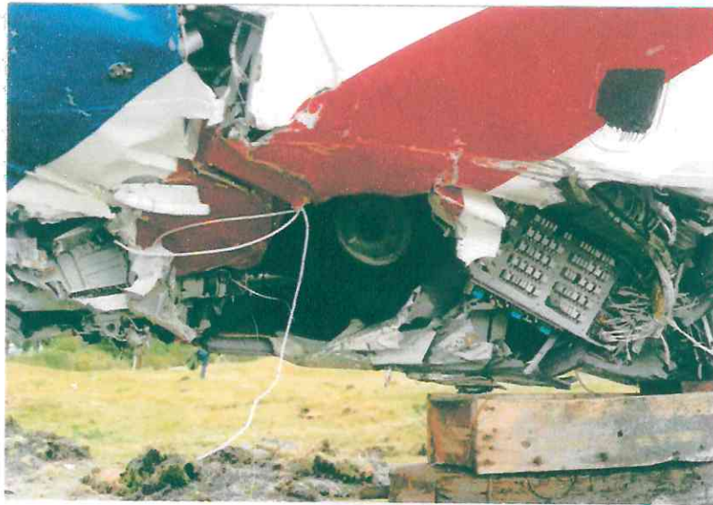
DAÑOS EN SECTOR DE COMPARTIMENTO ELECTRONICO
