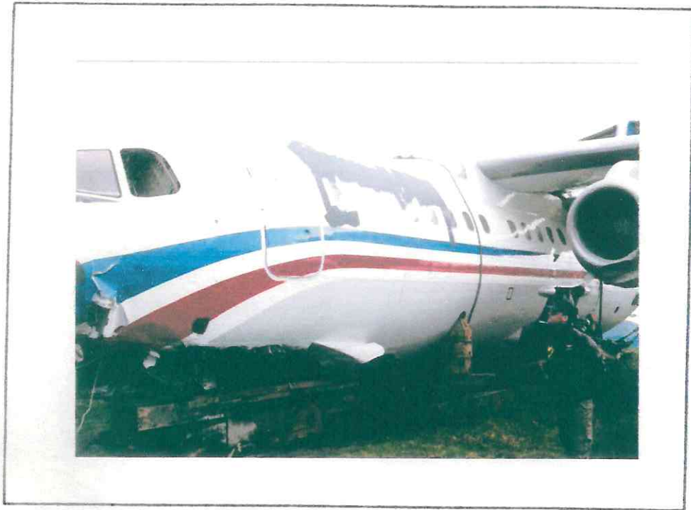
Vistas de daños desde el rãdomo hasta la sta. 312.5.
