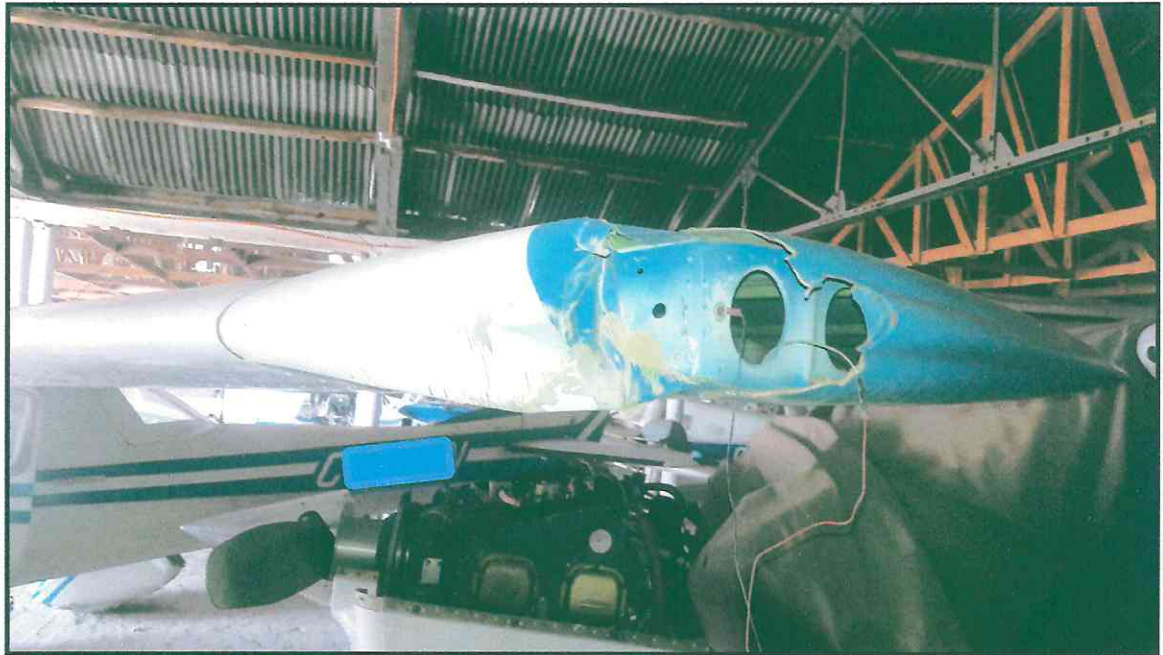
Fotografía N°4: Vista del daño en la punta del ala izquierda.
