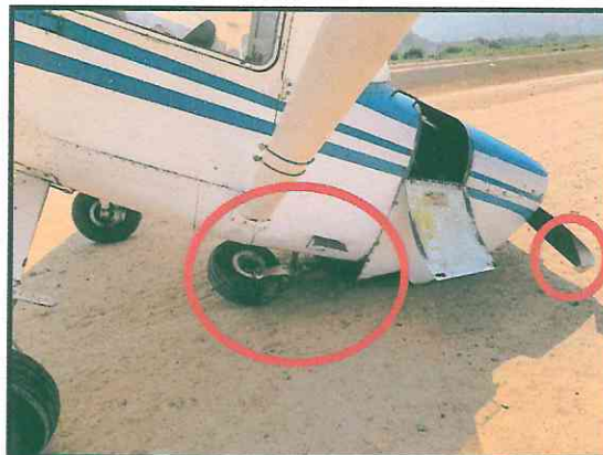
Fotografía 2: Daños en el tren de nariz y hélice.
