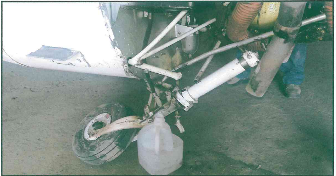
Fotografía N°2: Daños de la pierna de nariz.
