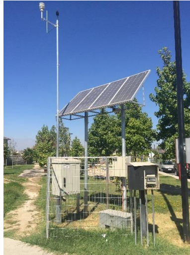
Ilustración 5 Terminales de monitoreo de ruido
