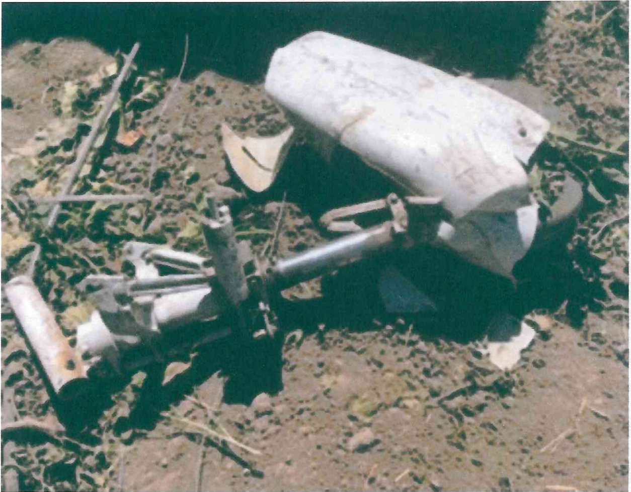
FOTOGRAFÍA N° 5. Muestra el tren de nariz, fracturado y desprendido del fuselaje.
