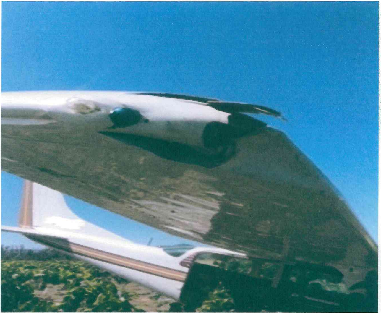
FOTOGRAFÍA N° 2. Muestra el daño en la punta del ala derecha.
