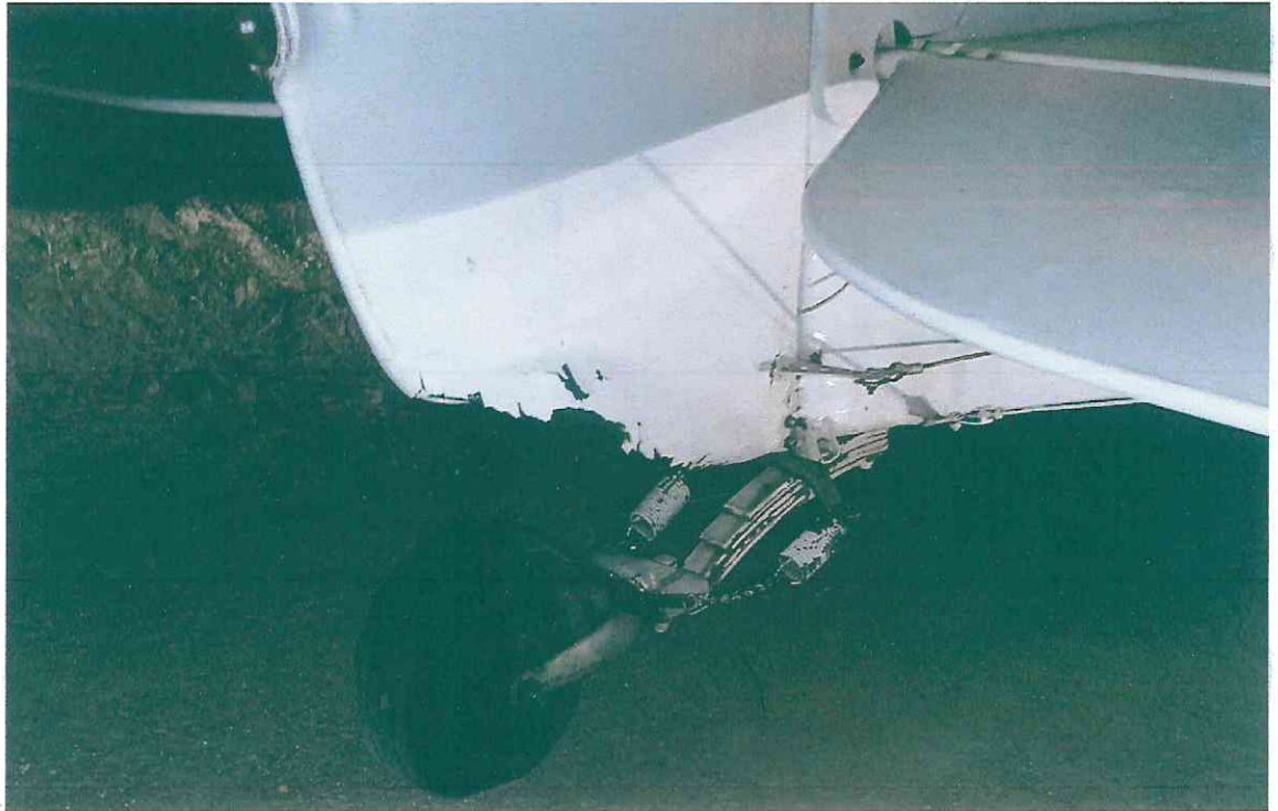
Imagen 4. Vista de la parte inferior del timón de dirección y patín de cola.
