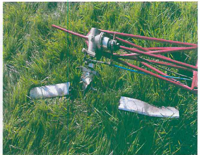
Fotografías N° 2 Y 3: Vistas del rotor de cola con sus palas quebradas.
