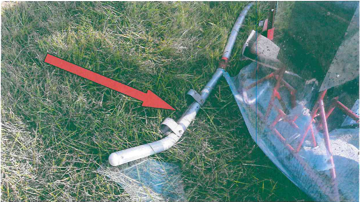
Fotografía N°7: Patín derecho con el anclaje para el Ballast (contrapeso).
