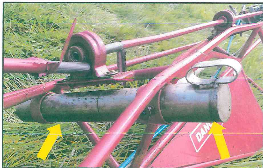
Fotografía 5: Contrapeso instalado en el cono de cola.
