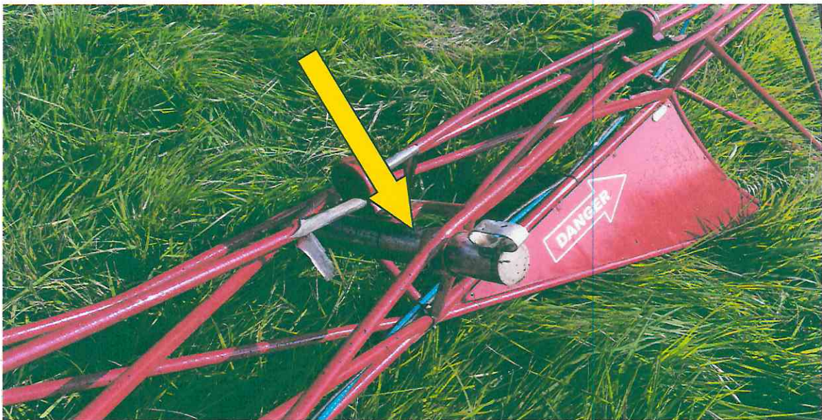
Fotografía N°6: Ballast (Contrapeso) de la aeronave en el punto de anclaje trasero.
