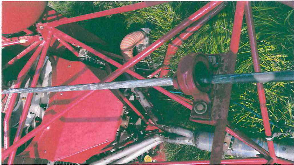
Fotografía N°4: Vista del eje de transmisión, deformado.
