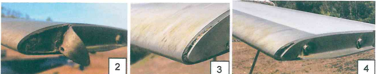
Fotografías N° 2, 3 y 4: Daños en la ferretería exterior (punteras) de las palas
