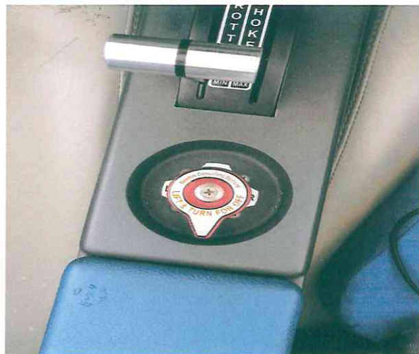
Fotografía N°3: Referencial Válvula de combustible
