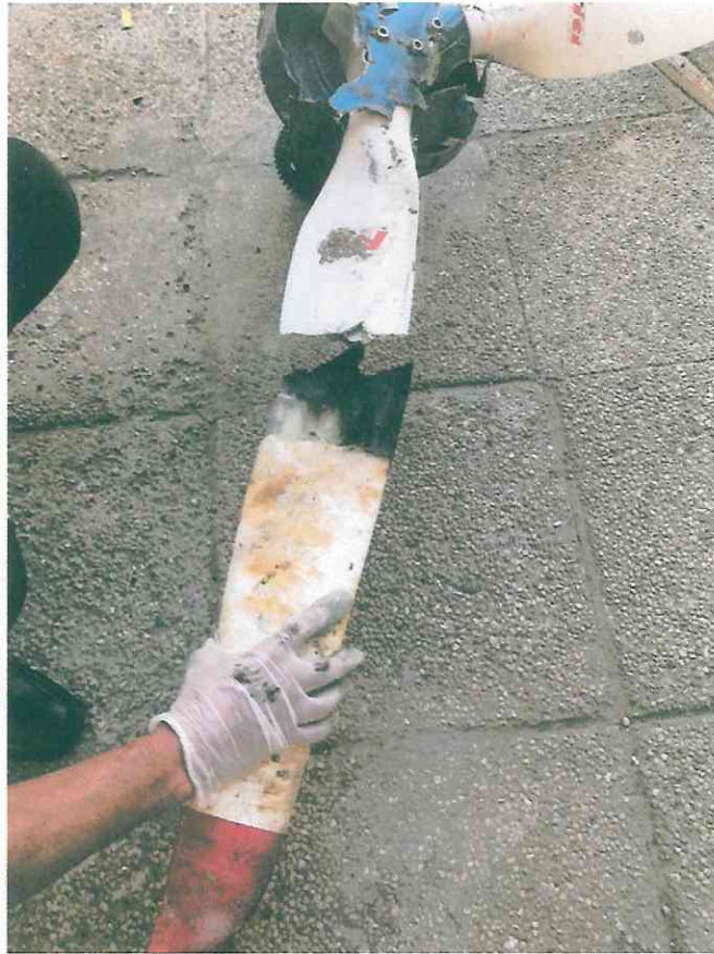
Imagen 3. Vista de la pala fracturada.
