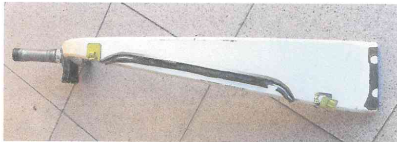
Fotografía N° 3. Vista superior de la pierna del tren principal del lado izquierdo.
