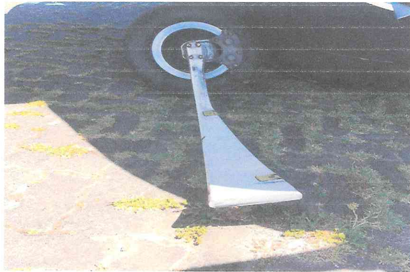
Fotografía 4: Pierna izquierda del tren de aterrizaje principal fracturada
