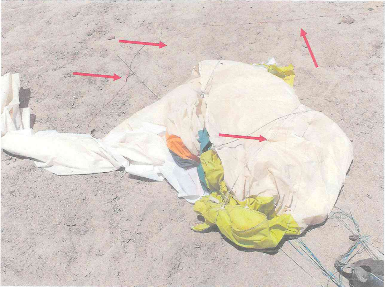
Fotografía 5: Vela con desgarros y varios suspentes o cuerdas de suspensión cortadas.
