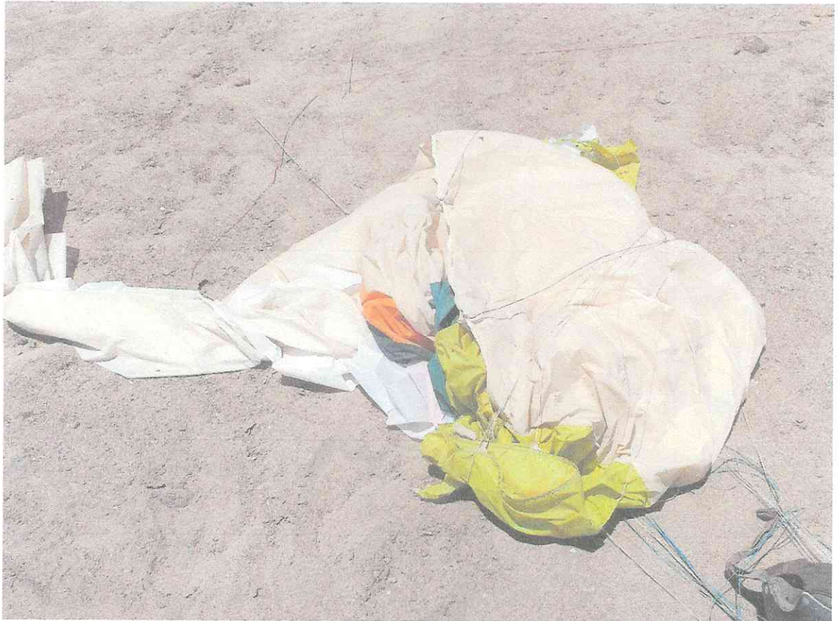
Fotografía N° 1. Daños en el recubrimiento y cuerdas de suspensión del parapente.
