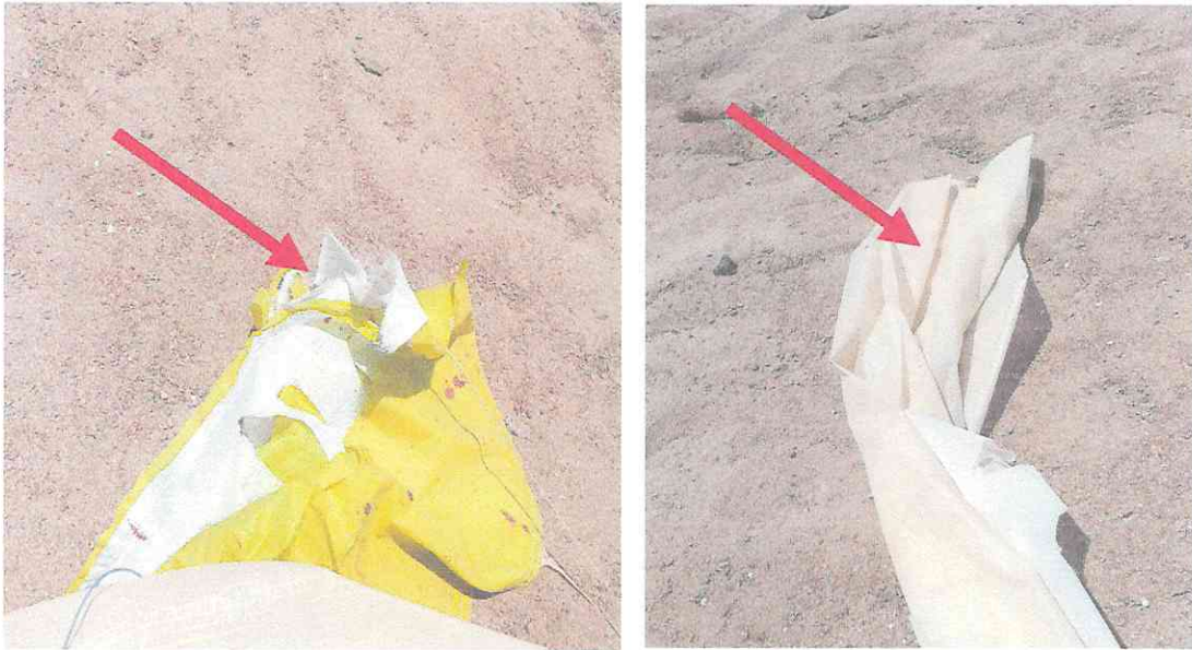
Fotografía 3 y 4: Vela colapsada o desgarrada, con varios suspentes o cuerdas de suspensión cortados.
