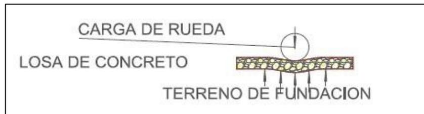
Figura 1-3-1. Transferencia de carga de una rueda en una estructura de pavimento rígido
