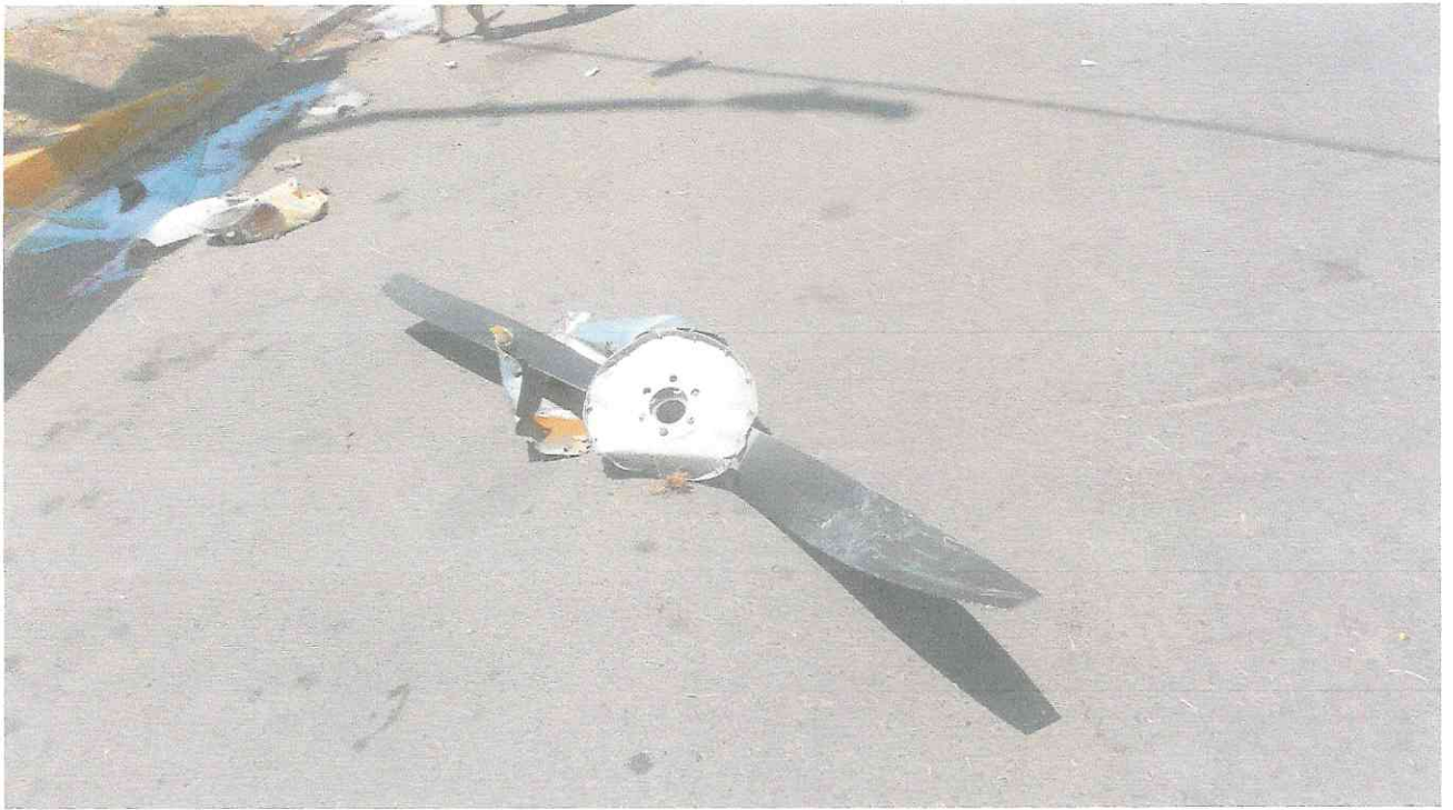
FOTOGRAFÍA N° 6. Muestra la hélice, la que quedó desprendida por el impacto.
