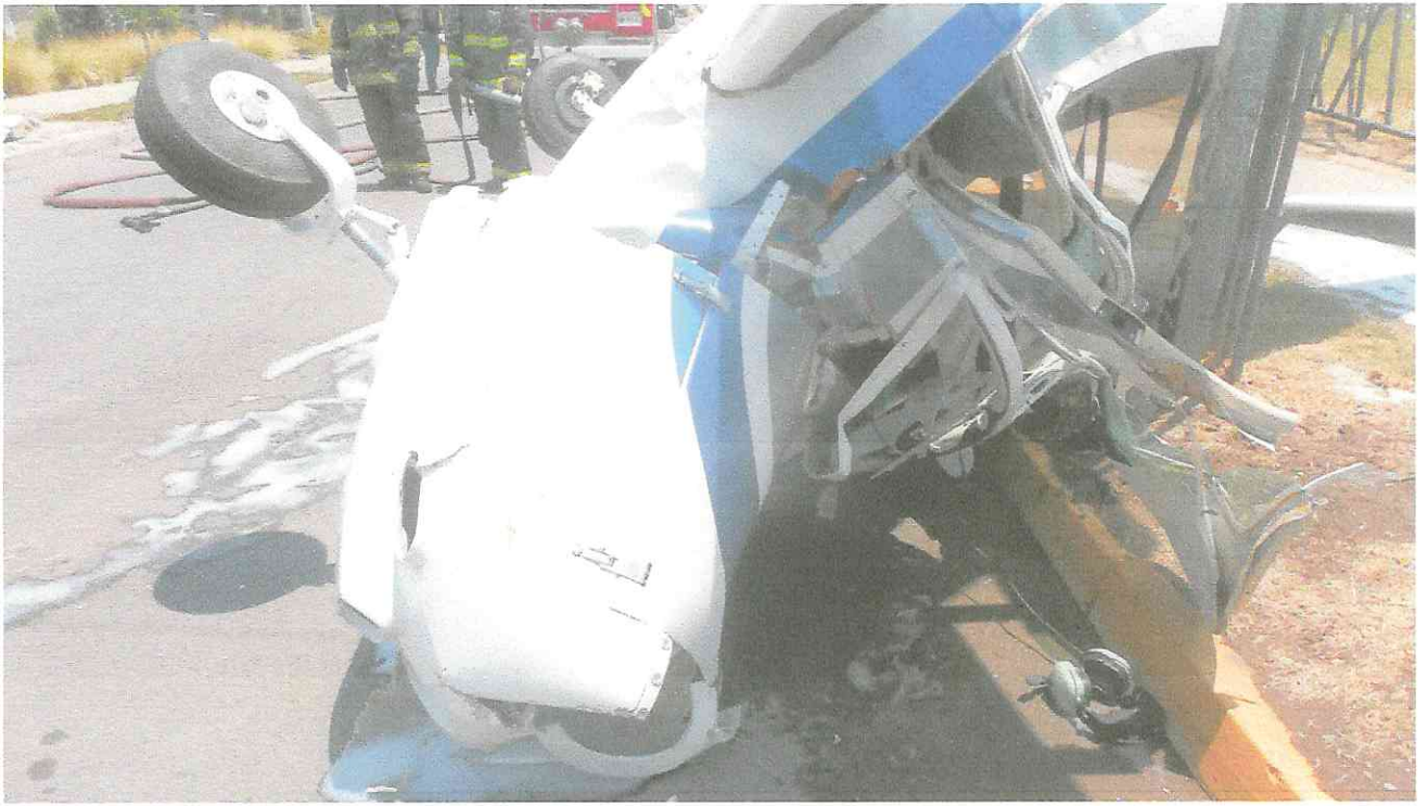
FOTOGRAFÍA N° 3. Muestra el daño en el fuselaje delantero, motor, hélice y cabina de mando.
