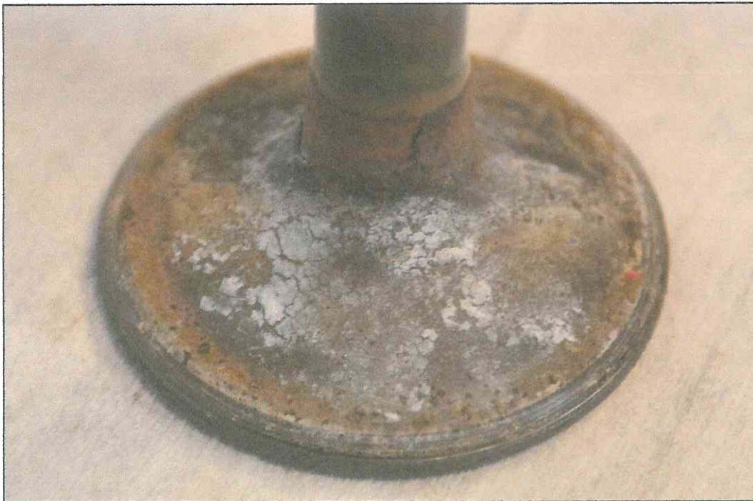
FOTOGRAFÍA 10 Válvula de escape del cilindro #1, con residuos de la combustión.
