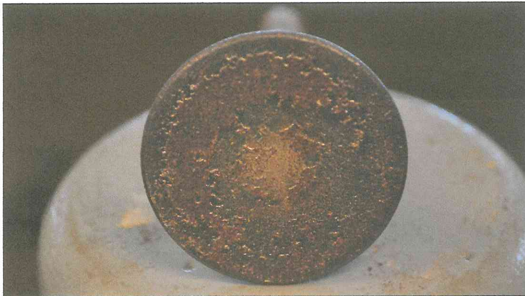
FOTOGRAFÍA 12 Válvula de escape del cilindro #1, con residuos de la combustión.
