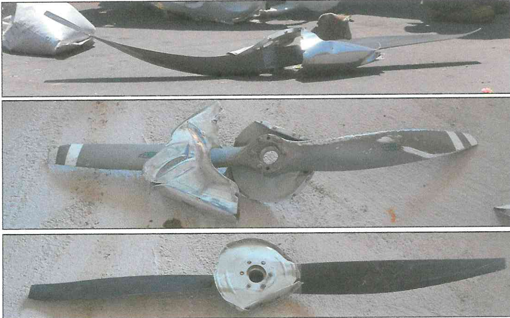
FOTOGRAFÍA 05 Daños en la hélice, con señales de giro a bajas revoluciones (rpm).
