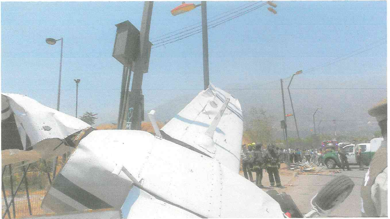
FOTOGRAFÍA N° 5. Muestra el daño en el tren de aterrizaje derecho, el cual quedó fracturado y desprendido.
