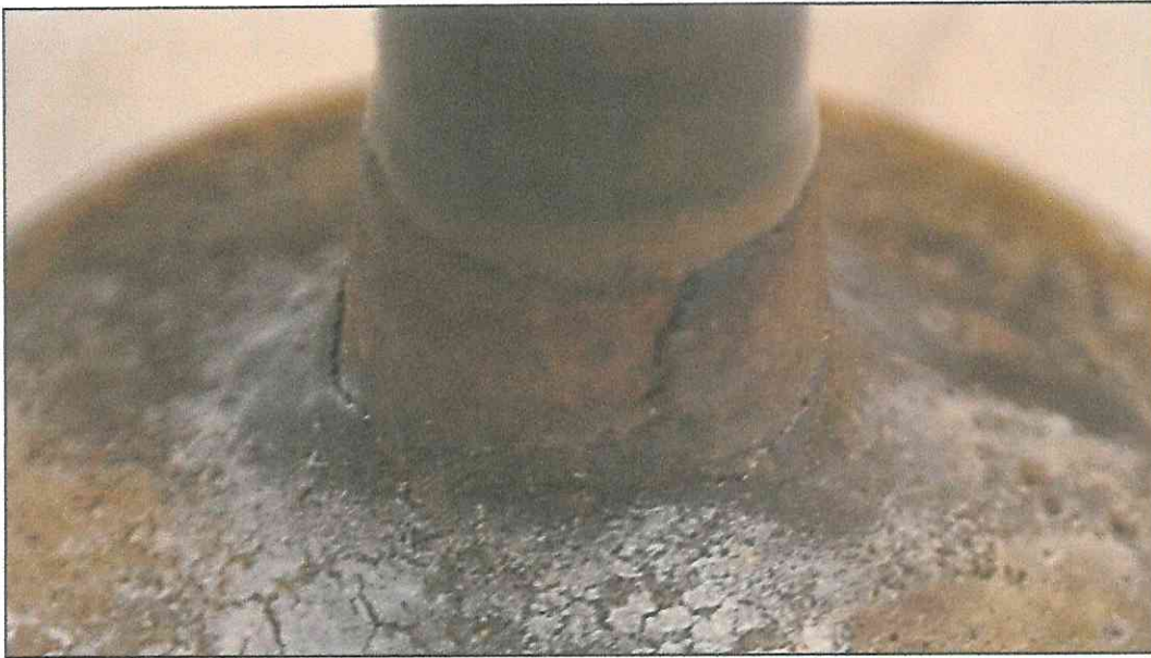
FOTOGRAFÍA 11 Válvula de escape del cilindro #1, con residuos de la combustión.
