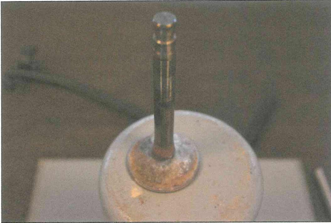
FOTOGRAFÍA 09 Válvula de escape del cilindro #1, con residuos de la combustión.
