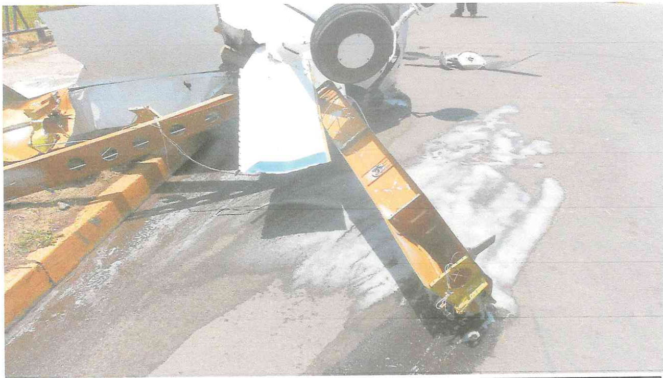
FOTOGRAFÍA N° 2. Ala izquierda, con daños en su estructura.
