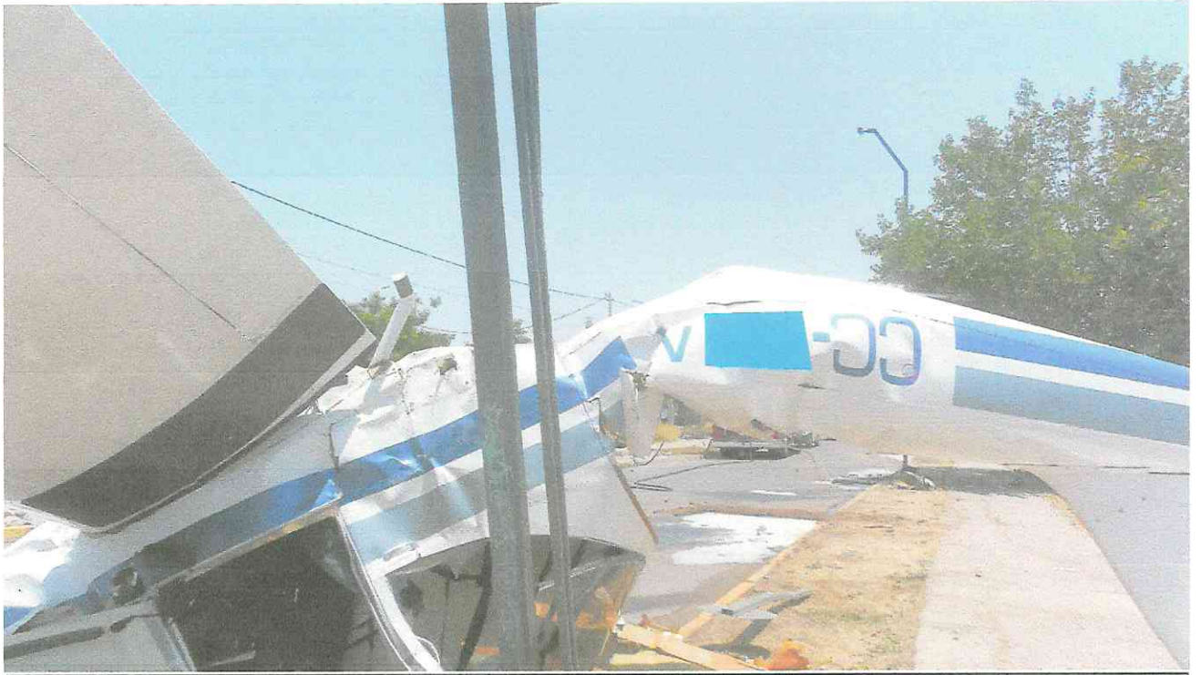
FOTOGRAFÍA N° 4. Muestra el daño en el fuselaje central.
