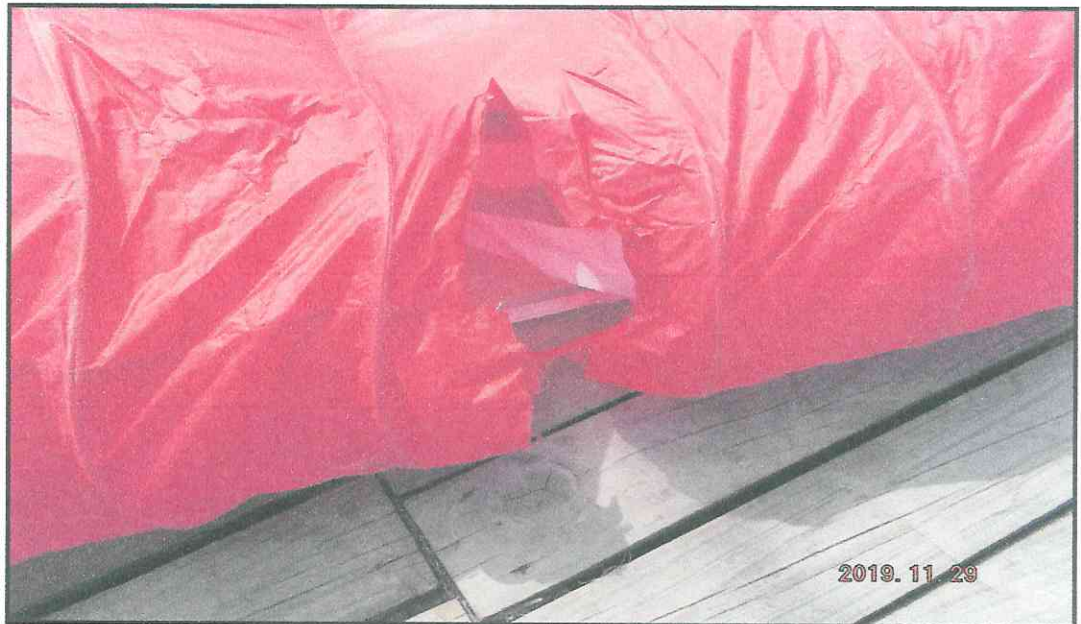
Fotografía 2: Daños en la parte frontal de la vela, por consecuencia del impacto contra el terreno.
