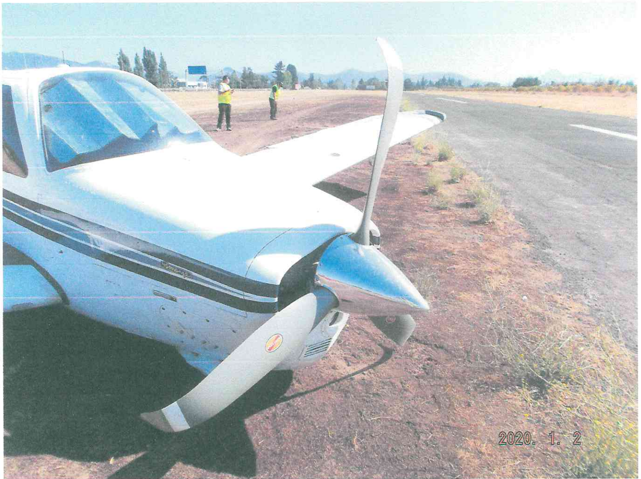
FOTOGRAFÍA N° 2. Muestra el daño en la punta de las tres palas de la hélice.
