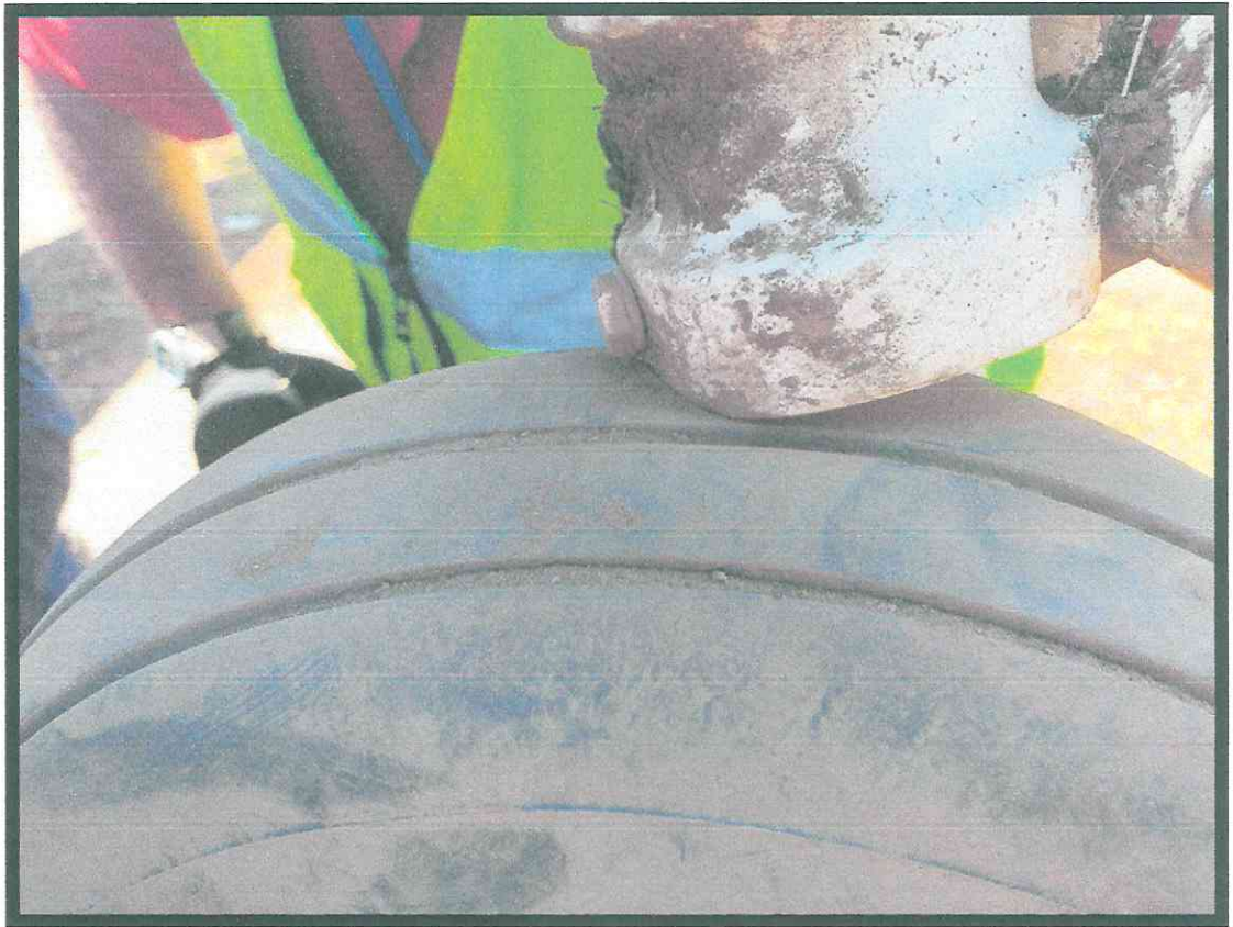
Fotografía N° 5: Rueda del tren de nariz trabada.
