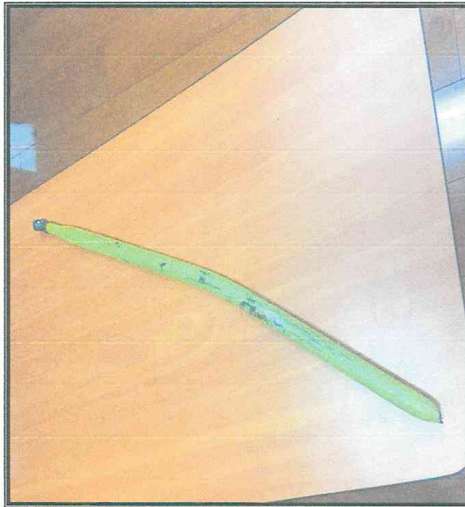
Fotografía N°7, Barra actuadora fracturada
