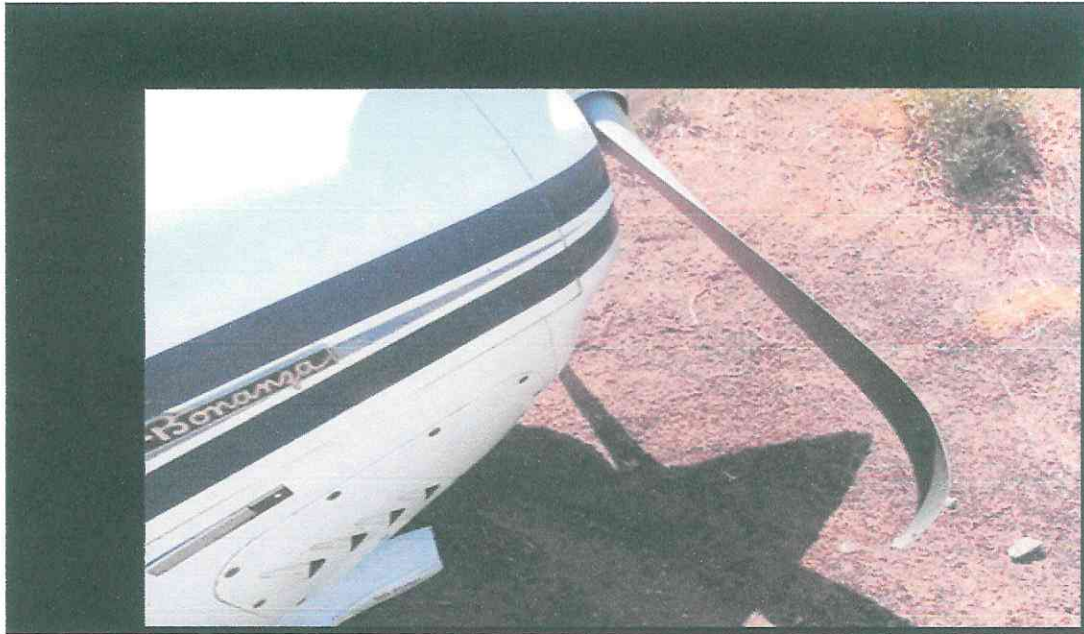
Fotografía N°4. Hélices con daños
