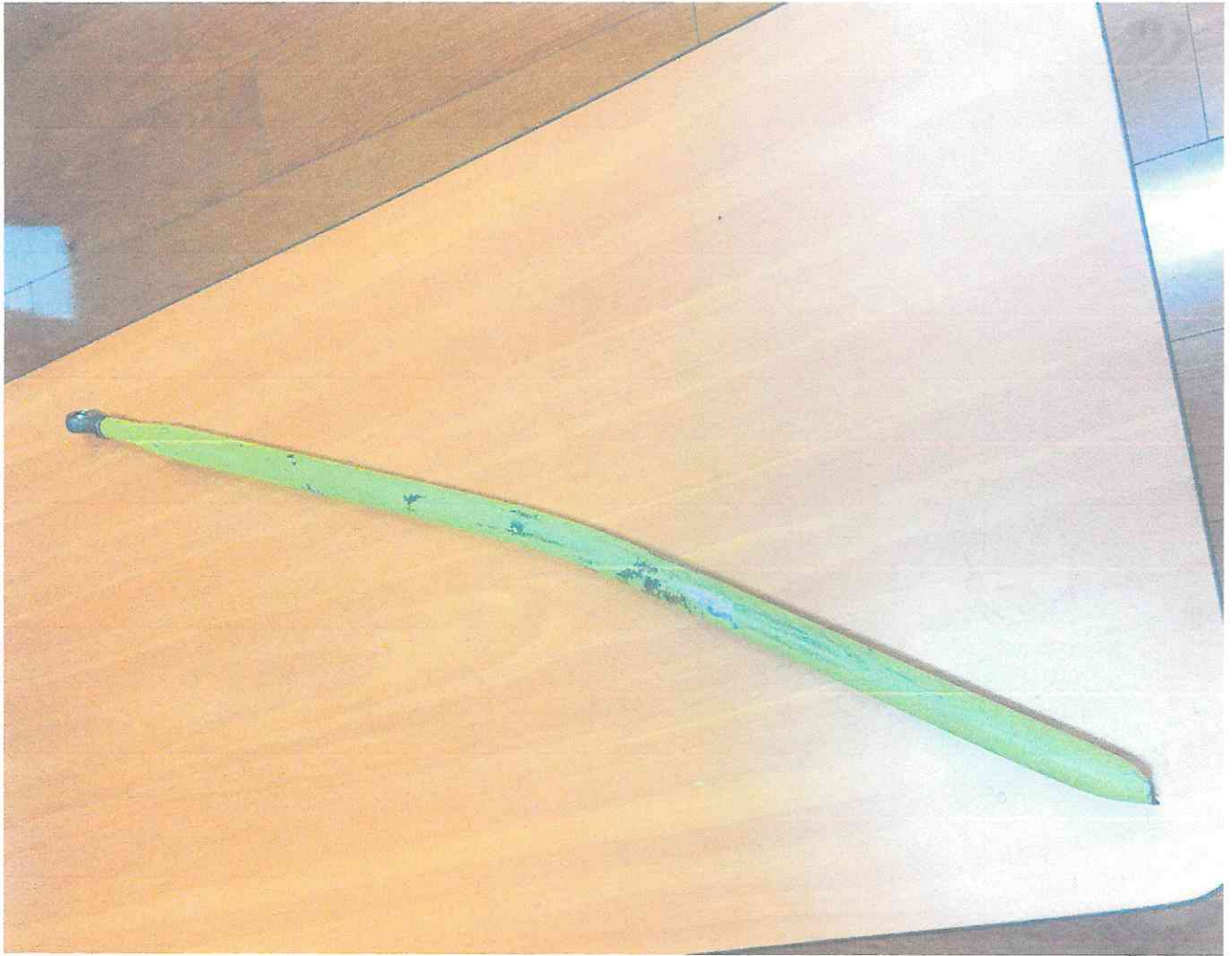
FOTOGRAFÍA N° 6. Muestra la barra actuadora del tren de aterrizaje de nariz fracturada.
