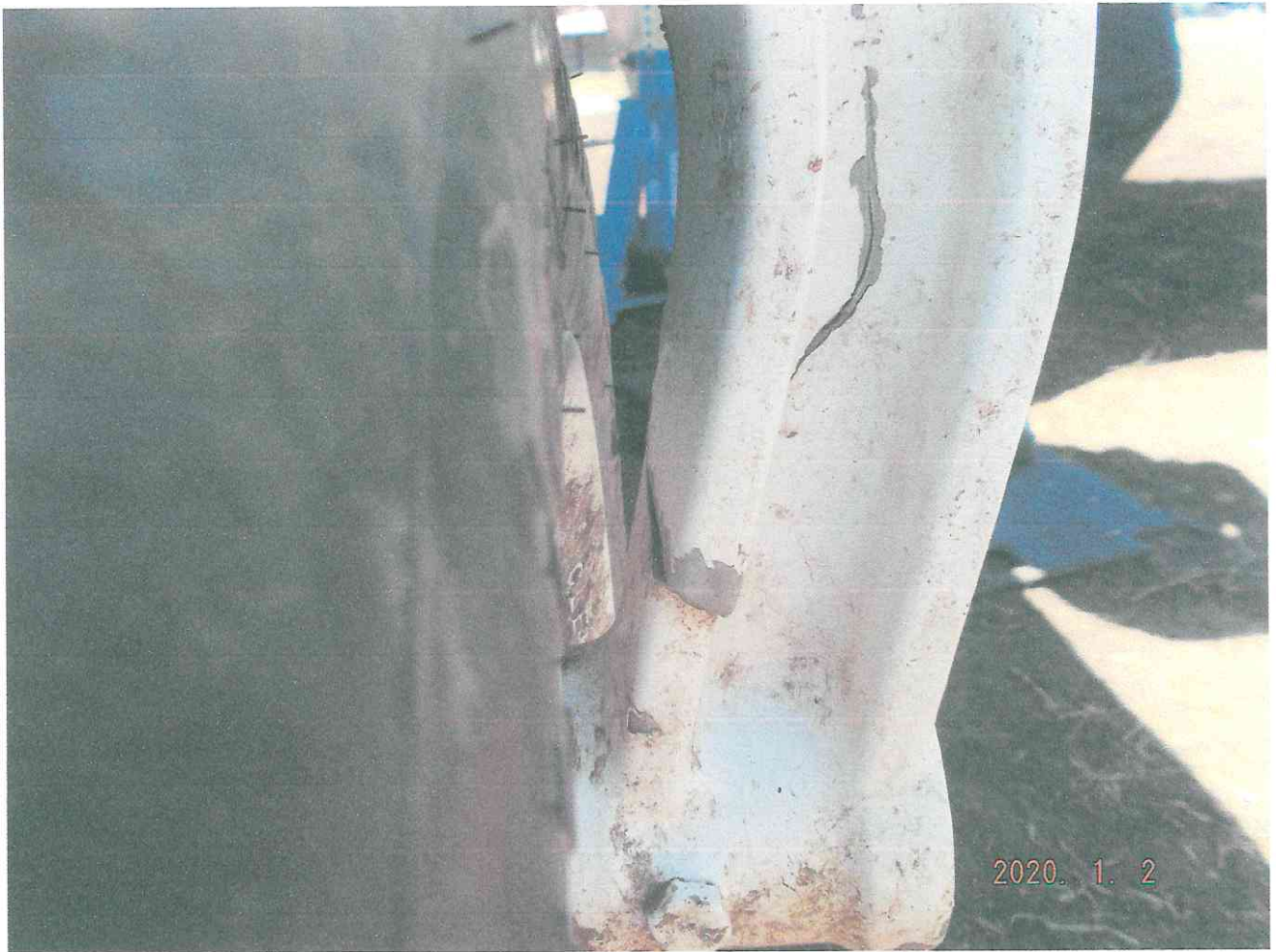
FOTOGRAFÍA N° 4. Muestra la fractura de la horquilla del tren de aterrizaje de nariz.
