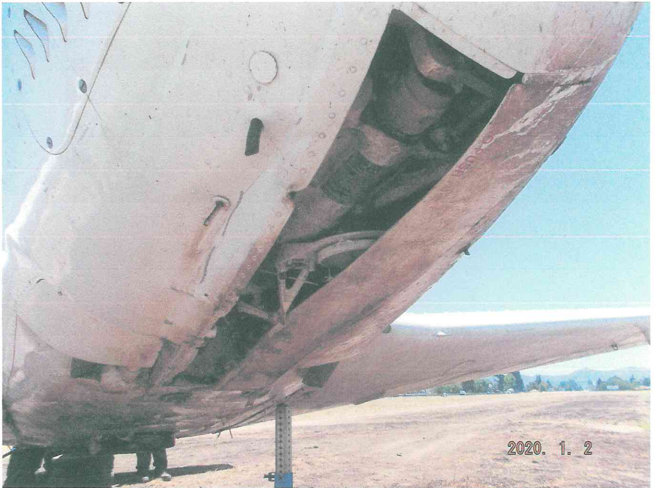
FOTOGRAFÍA N° 3. Muestra el daño en el fuselaje delantero, parte ventral.
