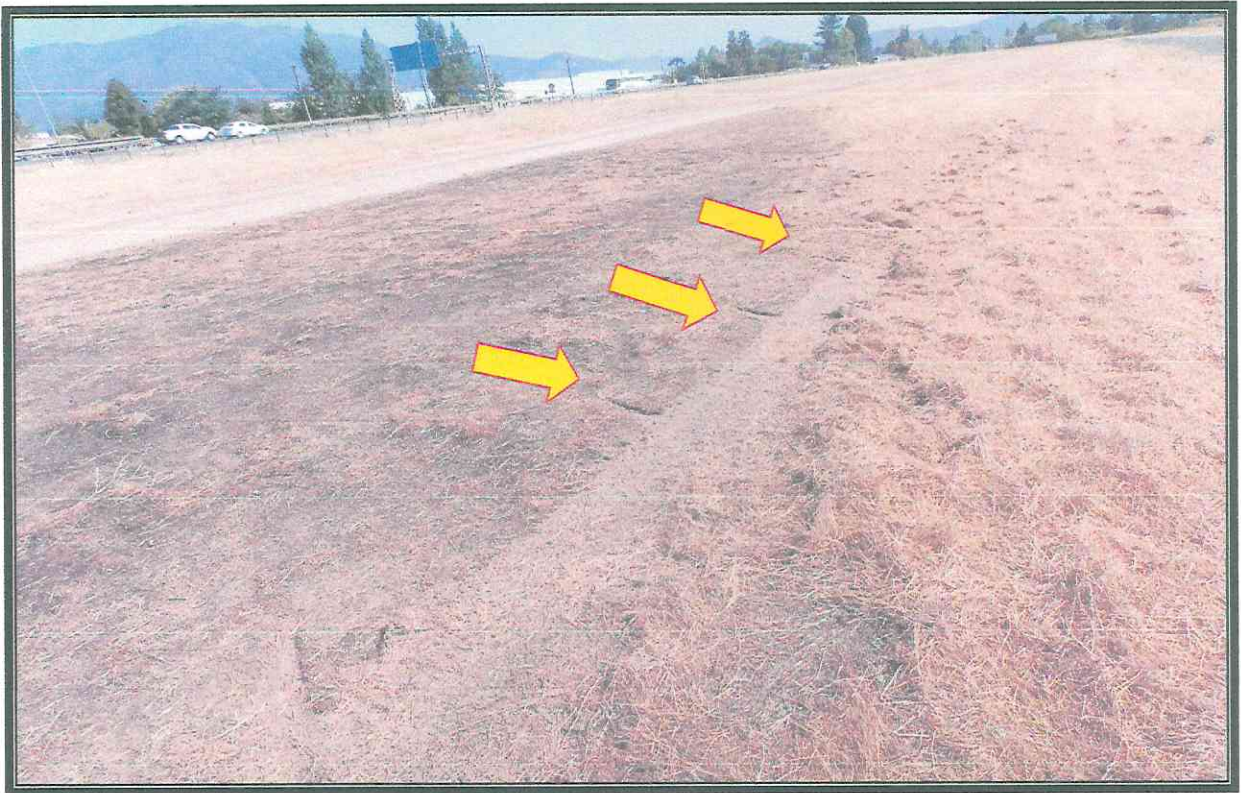
Fotografía N°2 Marcas de las palas de la hélice.
