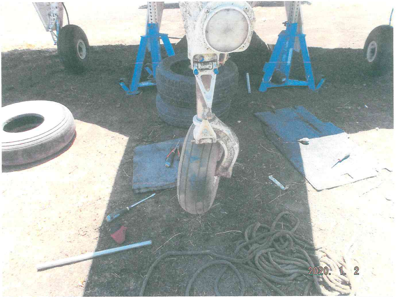
FOTOGRAFÍA N° 5. Muestra la torción de la horquilla del tren de aterrizaje de nariz.
