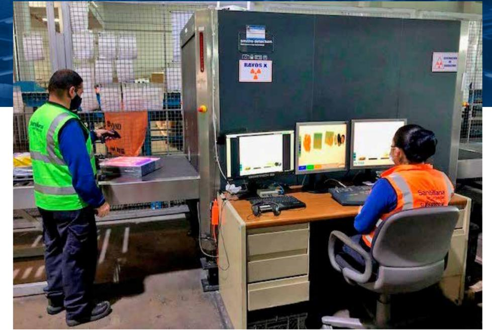
Equipo detector de traza - Máquinas de Rayos X de Doble Generador - Cámara de CCTV
