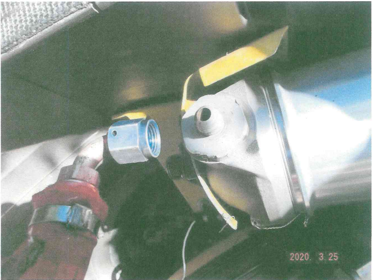
FOTOGRAFÍA N°5. Muestra la línea de salida del filtro de combustible hacia el motor, la que estaba sin combustible.
