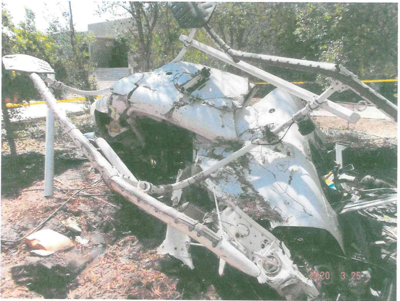
FOTOGRAFÍA N 3. Muestra el daño en el tren de aterrizaje.
