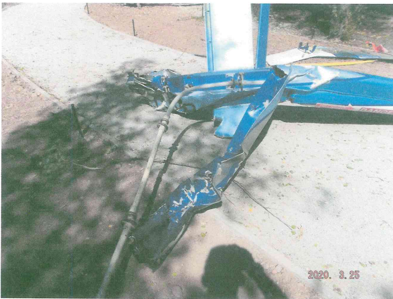
FOTOGRAFÍA N°2. Muestra el daño del cono de cola y estabilizadores.
