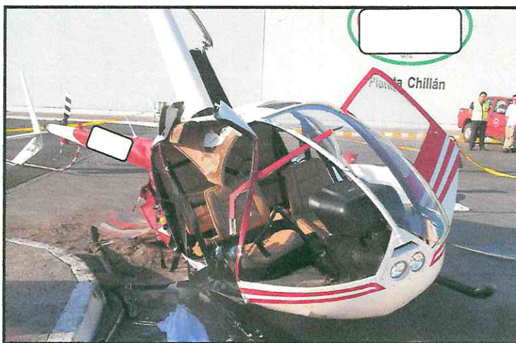
Fotografía N°3: Posición final y daños del helicóptero.
