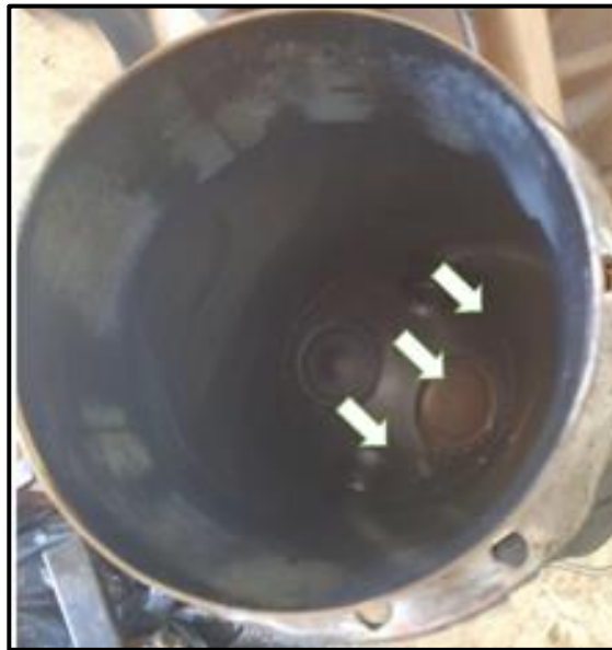
Fotografía 17. Partículas metálicas al interior de un cilindro.
