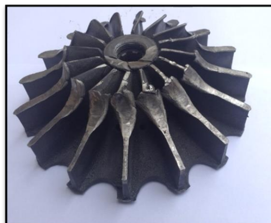
Fotografías 9 y 10: Daños en los alabes del impeller (compresor).
