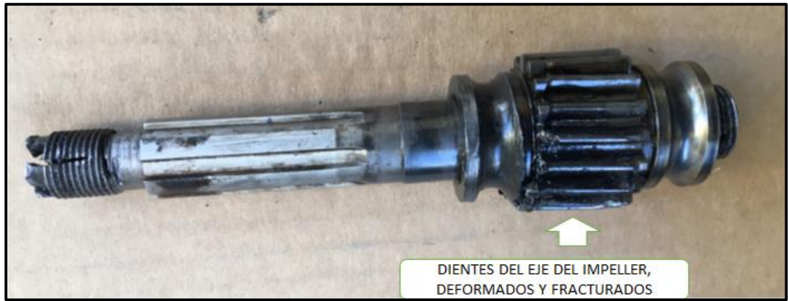
Fotografía 11: Eje del impeller, dañado.
