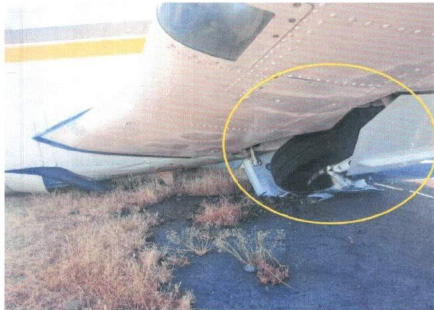
Fotografía N° 5: Vista lateral del tren de aterrizaje principal izquierdo y sus portalones.
