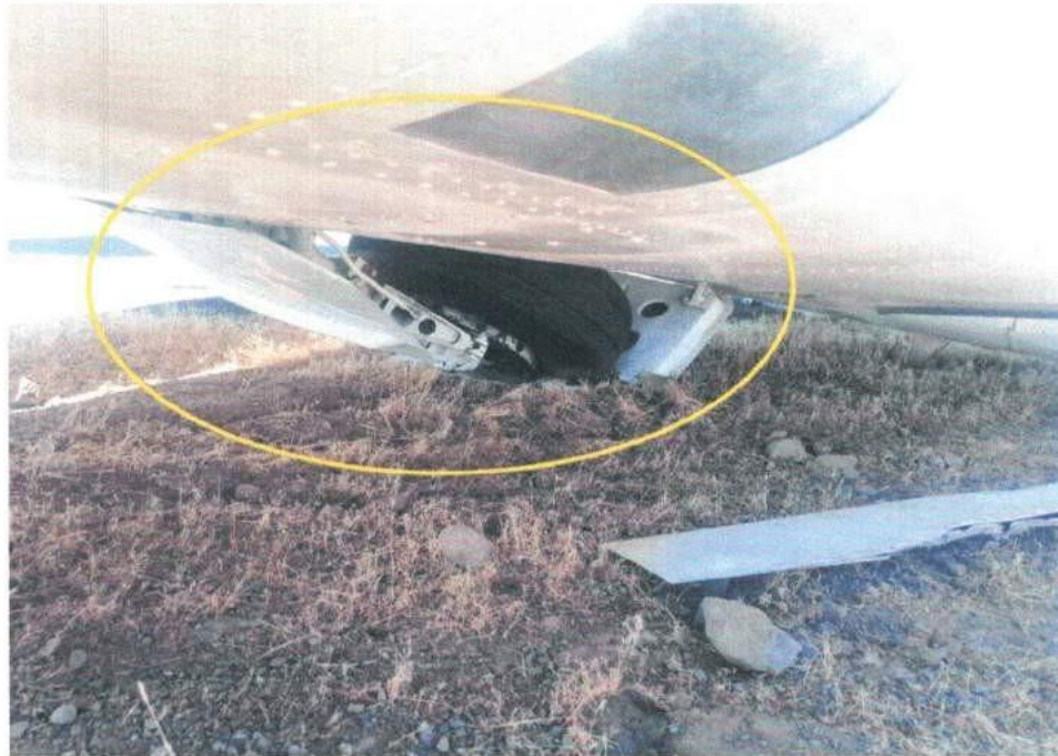
Fotografía N° 6: Vista lateral del tren de aterrizaje principal derecho y sus portalones.
