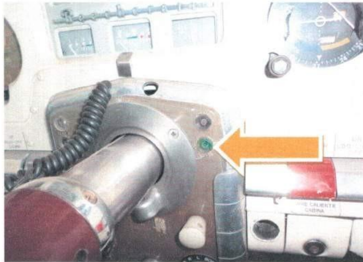
Fotografía N°6: Luz verde encendida indicando tren abajo y asegurado.
