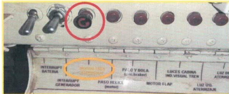
Fotografía N° 8: Disyuntor en posición afuera (círculo rojo).
