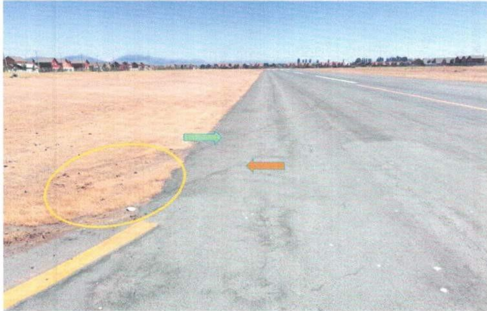
Fotografía N° 4: Vista de las huellas del arrastre del tren principal y zona de ubicación final de la aeronave.
