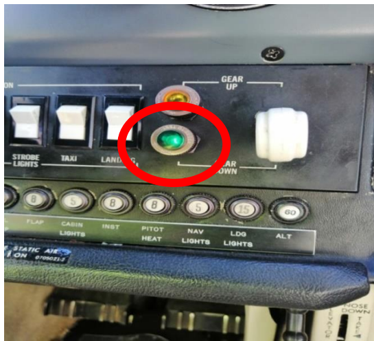
Fotografía N° 9: Luz verde de alarma del tren de aterrizaje, encendida y sin observaciones.
