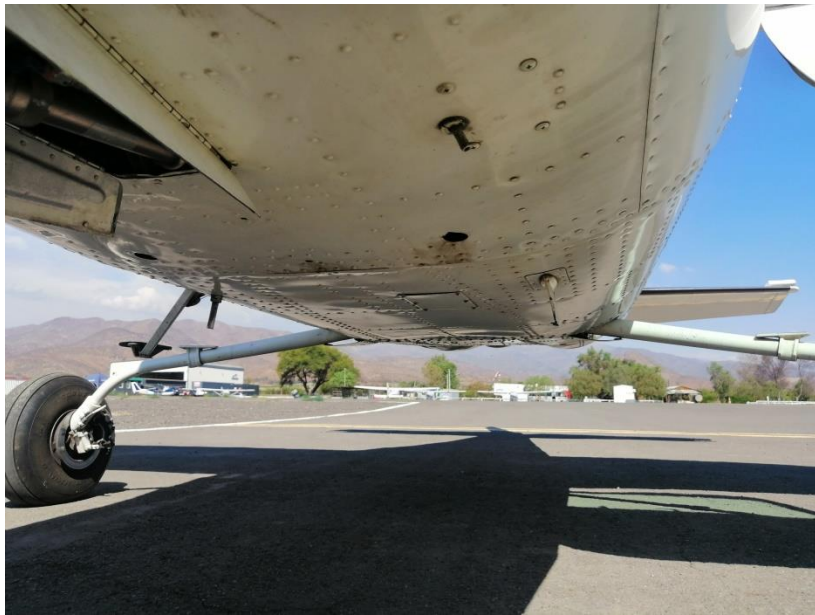
Fotografía N° 7: Vista de la parte ventral de la aeronave, sin daños, ni evidencias de arrastre.
