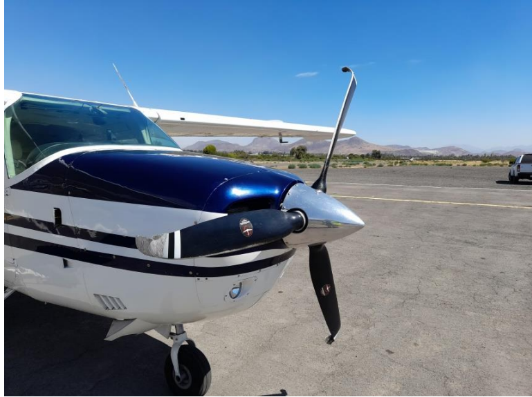
Fotografía N° 6: Vista lateral de la hélice con sus tres puntas de palas dobladas.
