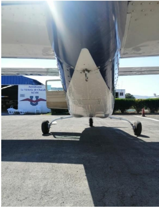
Fotografía N° 8: Vista posterior de la aeronave, sin daños, ni evidencias de arrastre.
