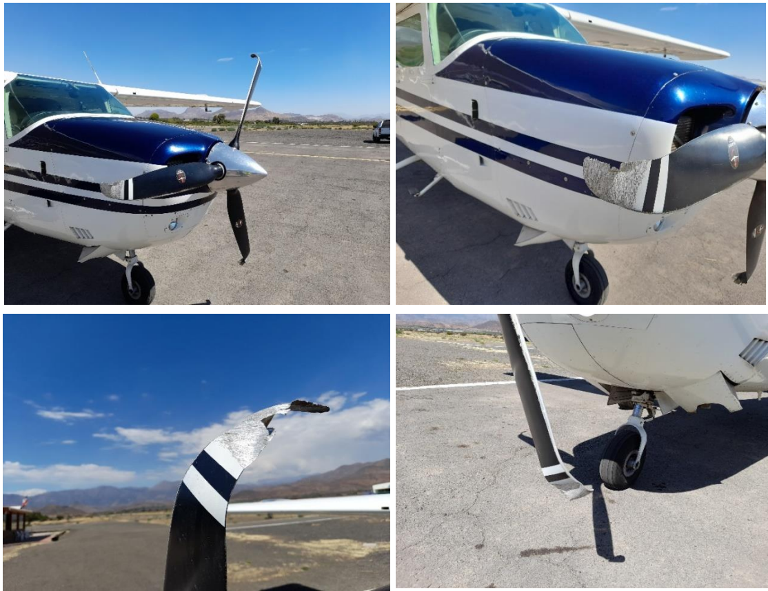
Fotografías N° 1, 2, 3 y 4: Vista de los daños de la hélice.
