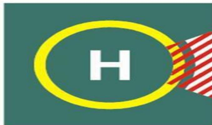
Figura A-5-10. Señal de sector de aterrizaje prohibido en la heliplataforma
