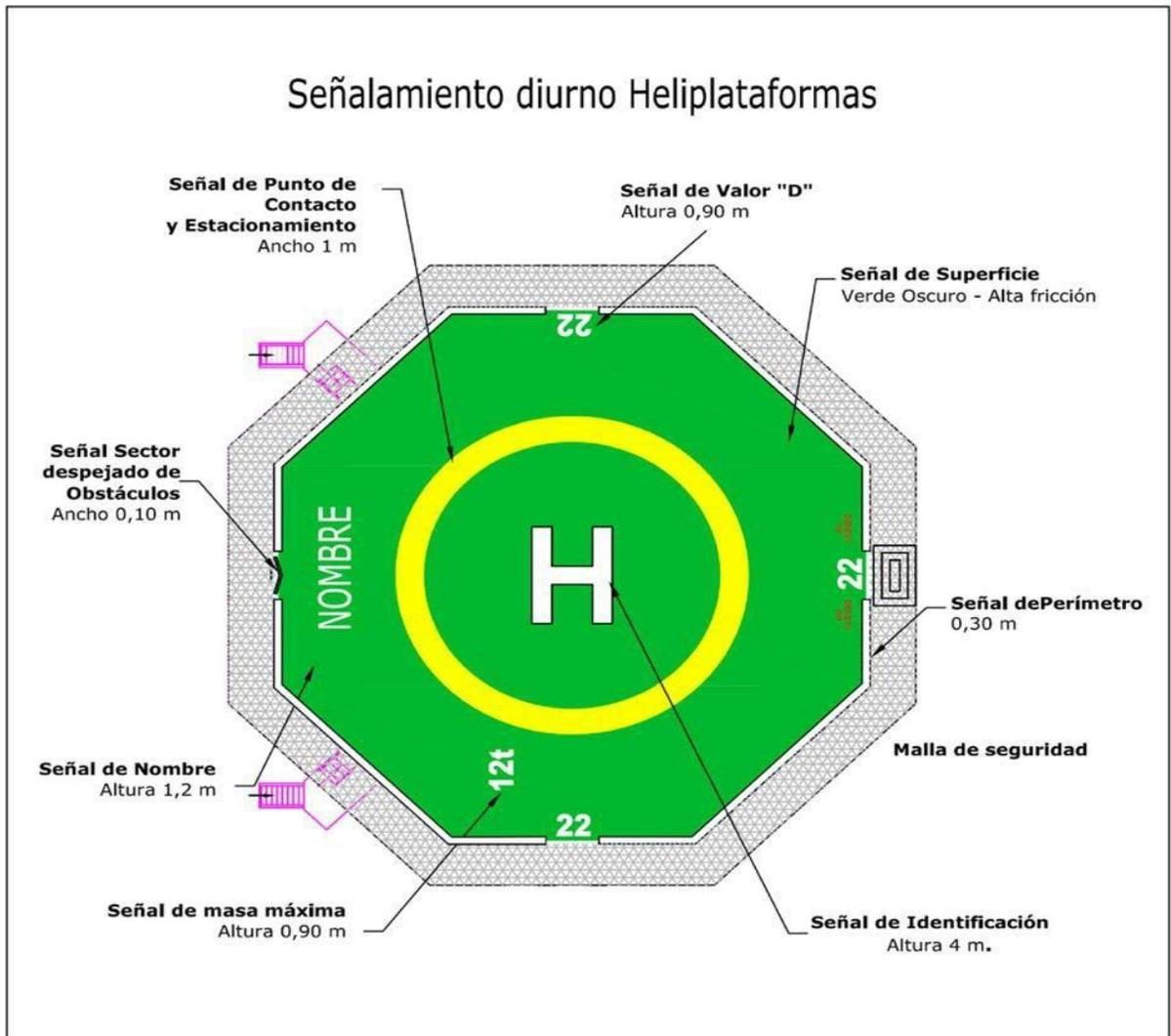
Figura A-5-8. Señalamiento de heliplataforma
