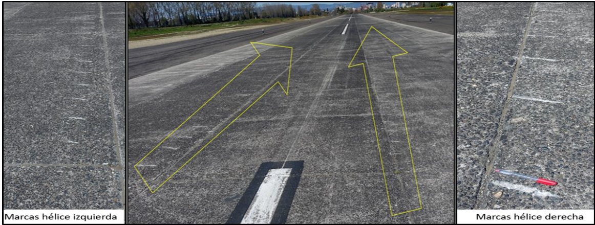
Fotografía N°12: Vista de las marcas realizadas por las hélices (izquierda y derecha) en la pista.
