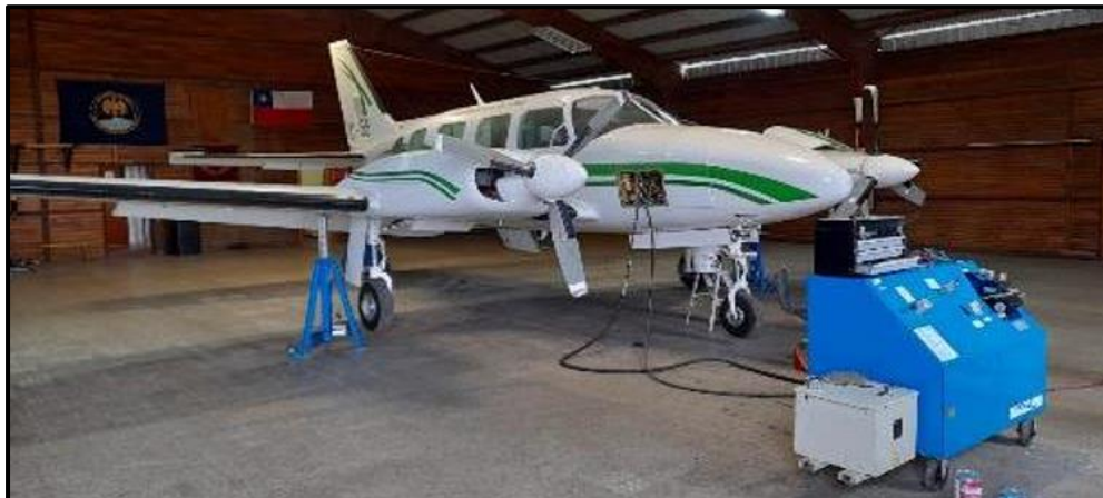
Fotografía N°9: Vista de la aeronave en gatas hidráulicas.
