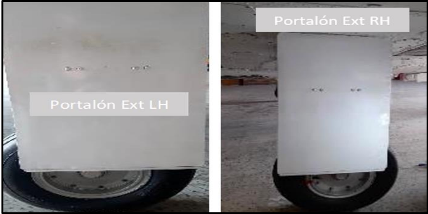
Fotografía N°5: Portalones exteriores LH y RH.
