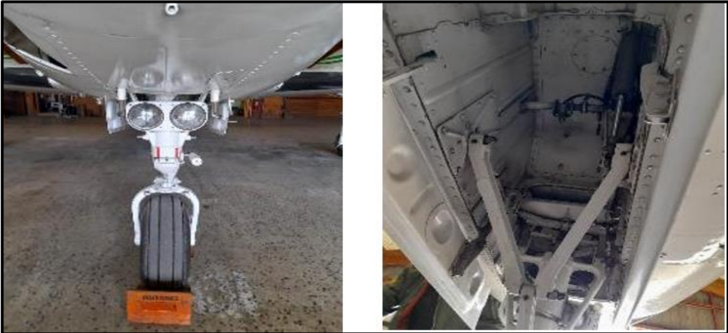
Fotografía N°7: Vista del tren de nariz.
