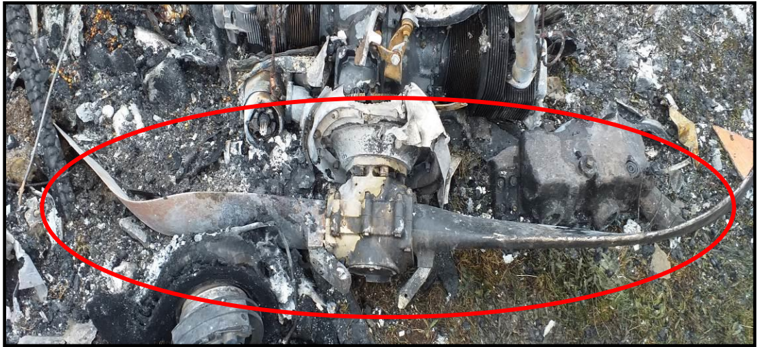
Fotografía 7: Ambas palas de la hélice con evidencia de baja potencia
