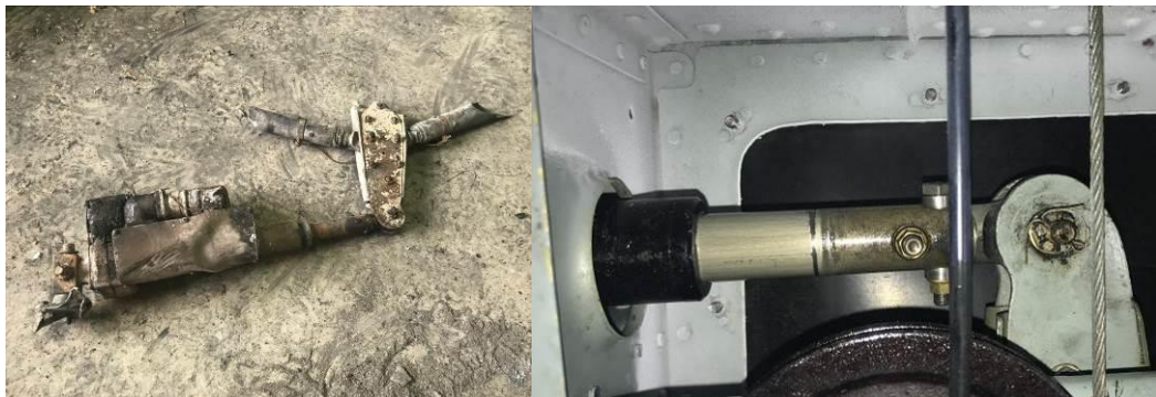
Fotografías 8 y 9: Actuador flaps, en comparación con aeronave del mismo modelo.
