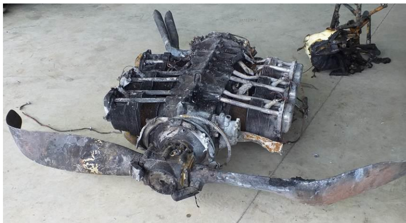
Fotografía 5. Deformación de las palas de la hélice del motor N° 2.
