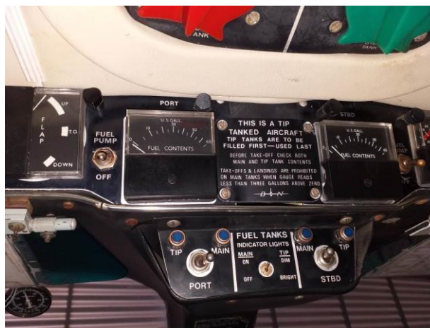
Fotografía 15. Panel superior de control de combustible (referencial)
