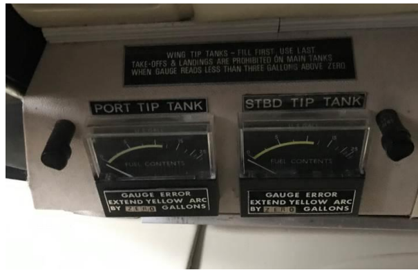
Fotografía 16. Indicadores de cantidad de combustible estanques de punta ala (referencial).
