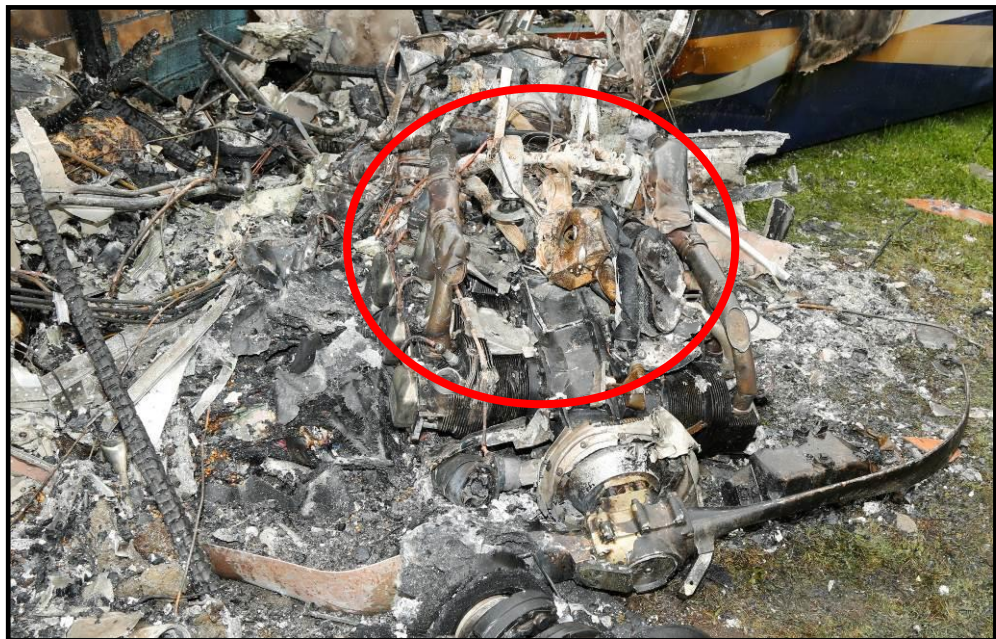
Fotografía 6: Motor N° 2 Destruído
