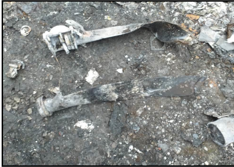
Fotografía 5: Ambas hélices desprendidas y evidencia de alta potencia
