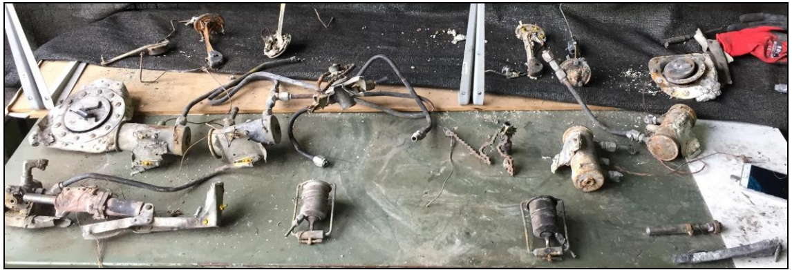
Fotografía 10. Componentes del sistema de combustible recuperados desde los restos de la aeronave.
