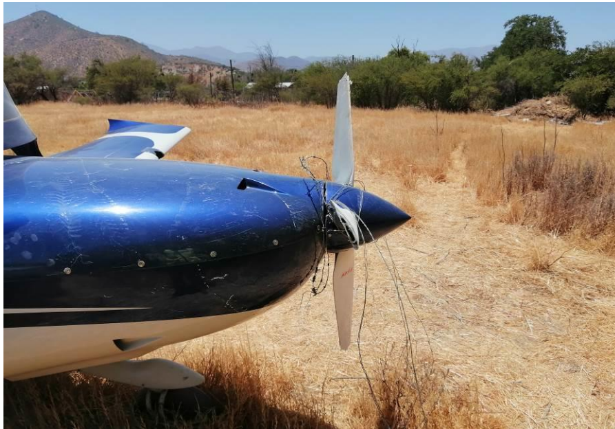
Fotografía 4: Alambres de púas en la zona de la hélice.
