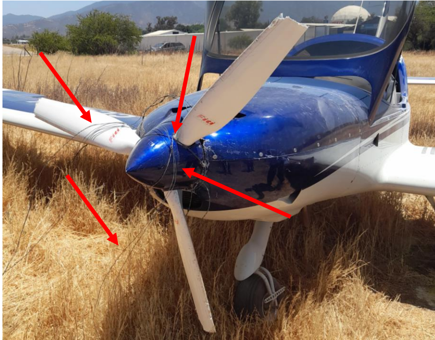
Fotografía N°5: Vista de la hélice con el alambre de púas enrollado.
