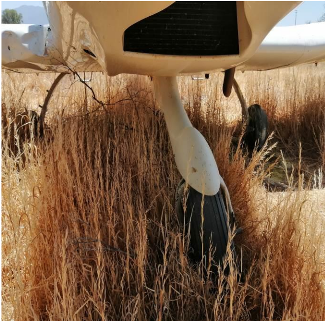
Fotografía 7 y 8: Tren de nariz y tubo pitot con daños.
