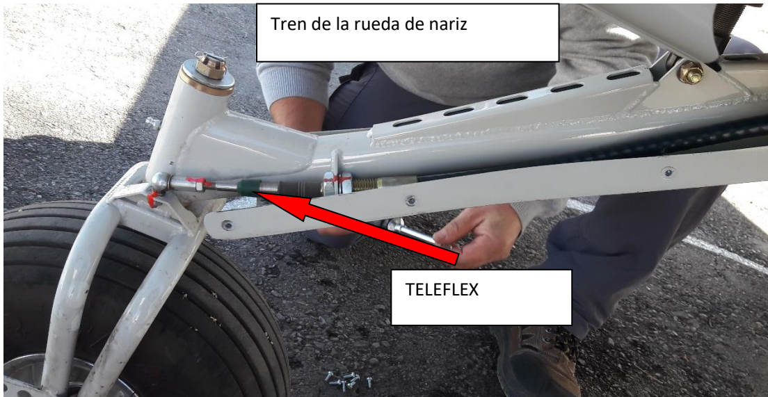
Fotografía N° 8: Vista referencial de la posición del mando teleflex.
