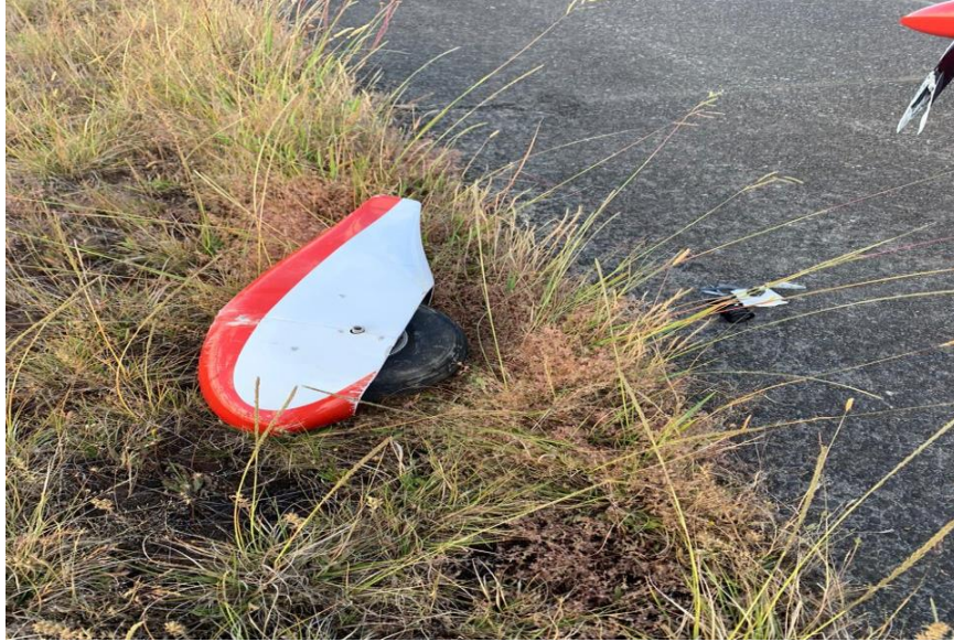
Fotografía N° 3: Rueda de nariz y carenado desprendida.
