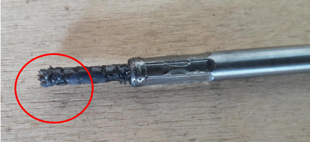
Fotografía N° 10: Vista del corte en el cable Tele Flex.
