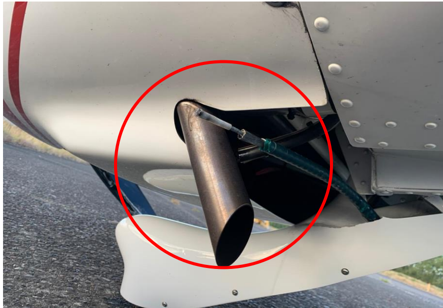
Fotografía N° 4: Mando teleflex de la rueda de nariz cortado.
