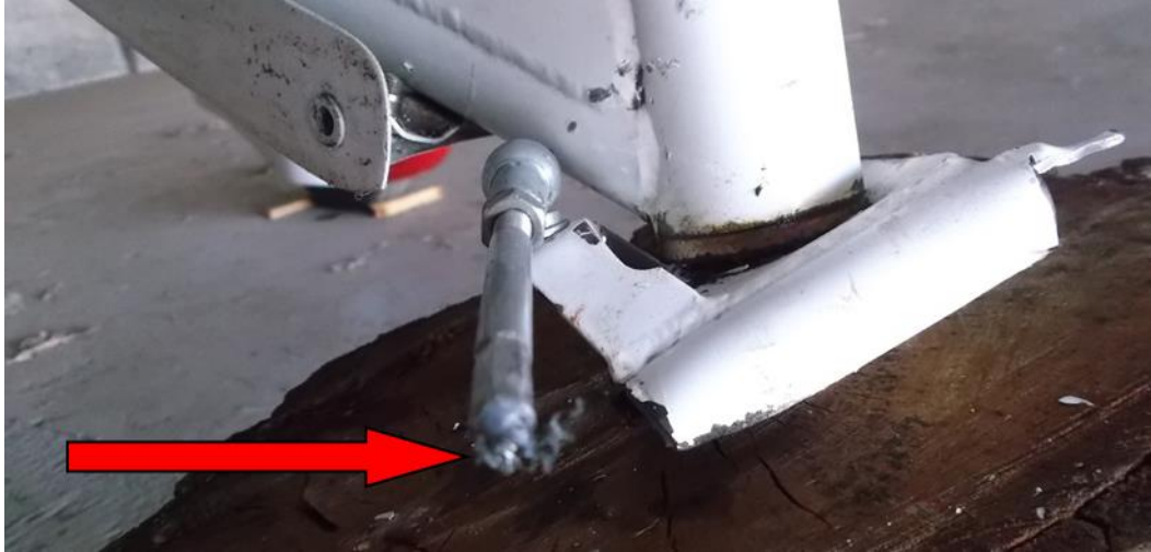
Figura N° 6: Vista del cable Teleflex cortado en la pierna de nariz.
